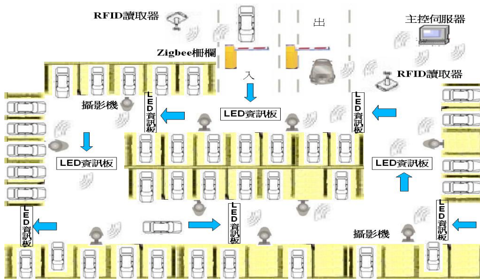
圖 7 基於無線射頻與電腦視覺技術的停車位導引系統軟硬體建置架構示意圖
