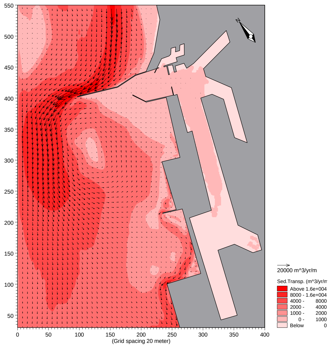
圖 5-30 10 年迴歸期颱風( H_s=5.5\text{m} ， T_s=9.8\text{sec} ，N 向)輸沙潛量分布圖(採用民國 94 年臺中港地形水深)
