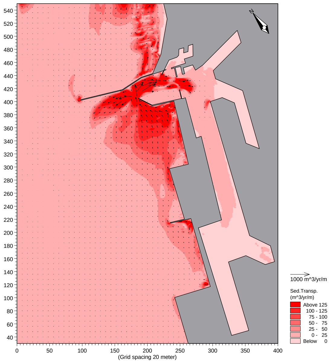
圖 5-29 夏季季風( H_s=0.9\text{m} ， T_s=6.3\text{sec} ，W 向)輸沙潛量分布圖(採用民國 94 年臺中港地形水深)
