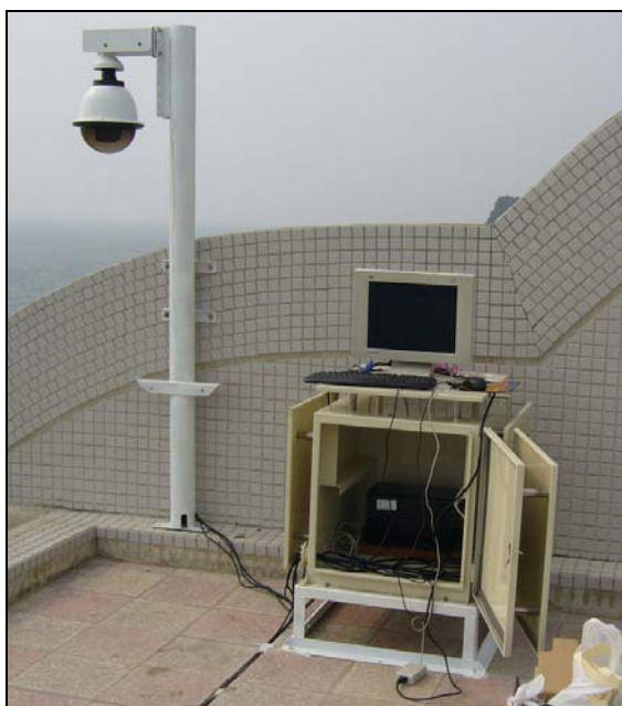
圖 4.1 影像儀器設備(攝影機、防水罩與觀測站主機)
