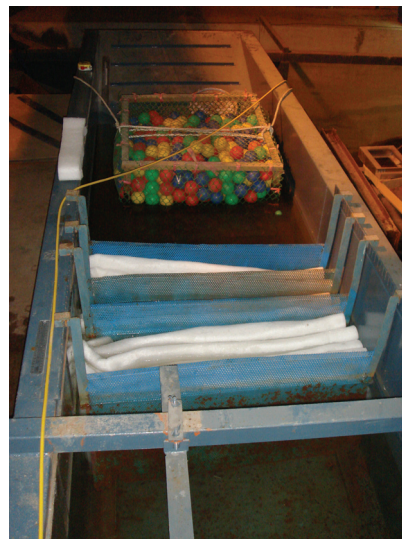
照片 5 小斷面水槽消波斜坡
