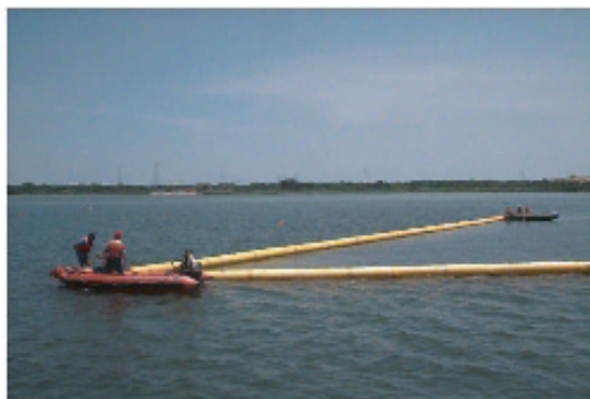
圖 21 RIBS 半比例尺現場實驗
