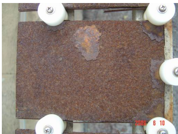
碳鋼-表面為暗紅色顆粒狀鬆散的腐蝕生成物，並有分層剝離的現象
