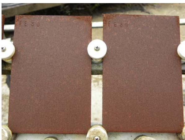
碳鋼-表面呈暗紅色顆粒狀密實的腐蝕產物
