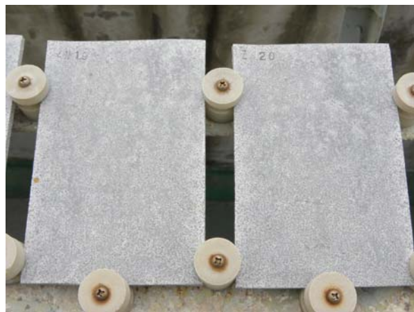
鋅片-表面為白色粉末狀鬆散的腐蝕生成物
