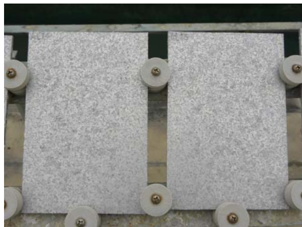
鋁片-表面為灰白色點狀粉末之腐蝕生成物
