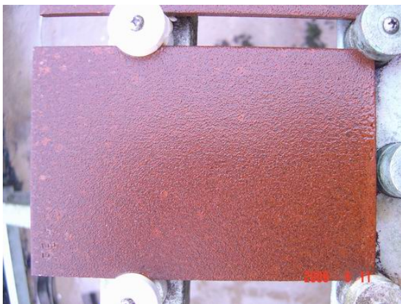
碳鋼-表面呈暗紅色顆粒狀密實的腐蝕生成物
