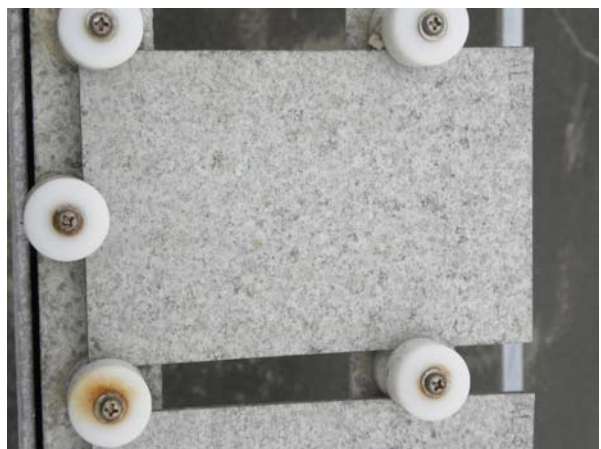
鋁片-表面為灰白與黑色點狀粉末之腐蝕生成物
