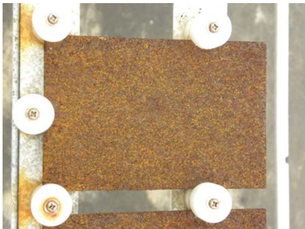
碳鋼-呈暗紅色顆粒狀鬆散之腐蝕產物
