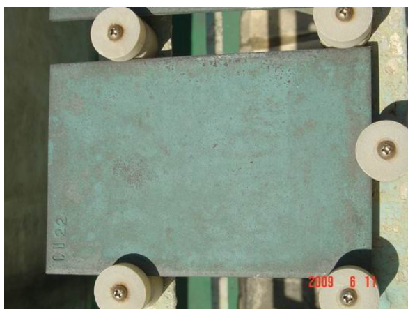
銅片-表面為綠色粉狀之腐蝕生成物
