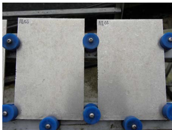
鋁片-表面接近金屬色，少部分有白色點狀的腐蝕現象
