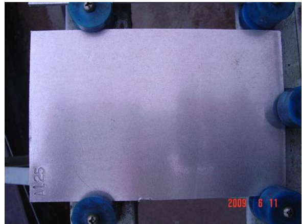
鋁片-表面為金屬色，幾乎無腐蝕現象
