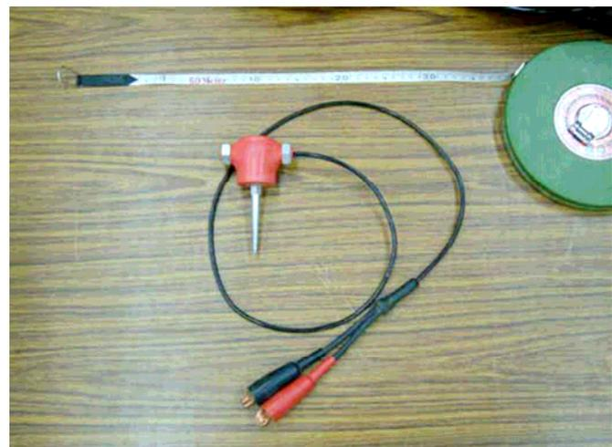
圖 3.10 高感度電磁式速度受波器(4.5Hz)
