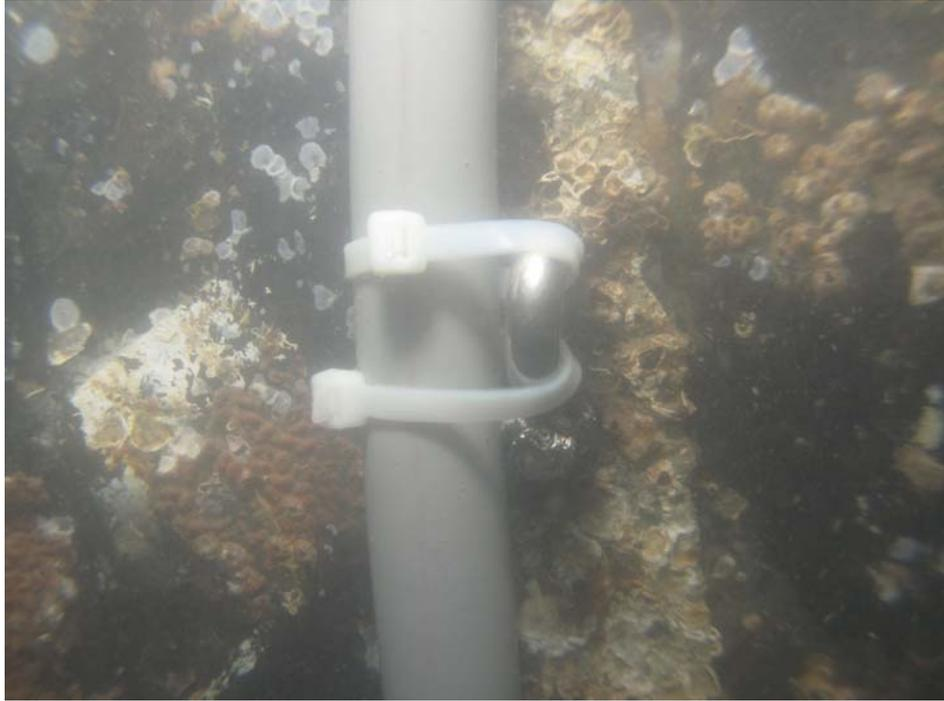
圖 5.3 動態剖面位移計水下安裝完成圖
