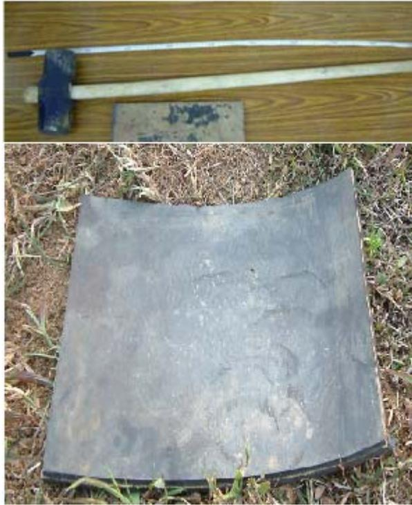
圖 3.11 長柄手持式鐵錘及橡皮軟墊
