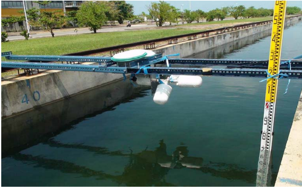
圖 3.5 中型水槽架設 RHCP,LHCP,與水準尺位置
