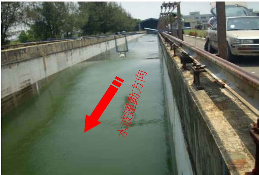
圖 4.1 成功大學臺南水工試驗所大型斷面水槽
