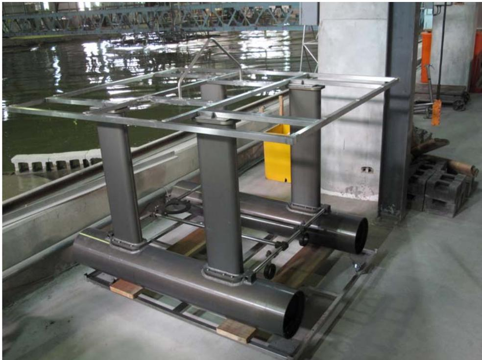
圖 2.25 無人船體之照片，目前正進行系統整合測試
