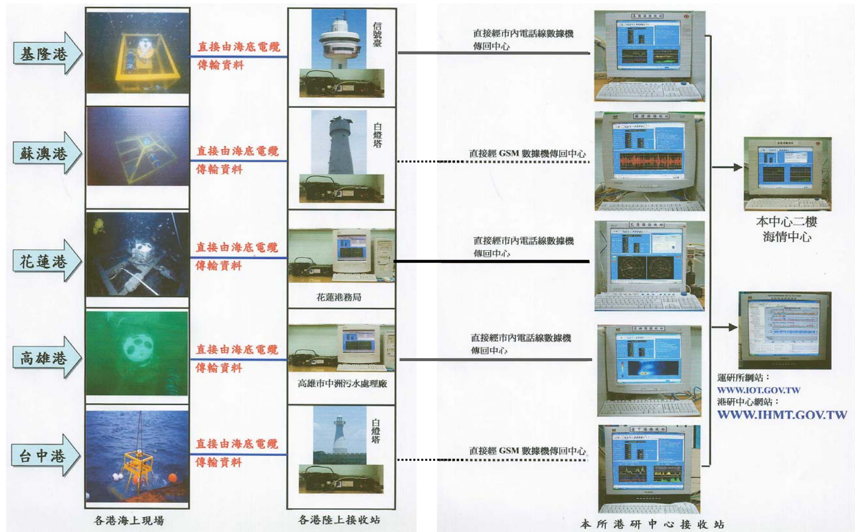
圖 2.9 五個國際港海氣象觀測站系統架構示意圖
