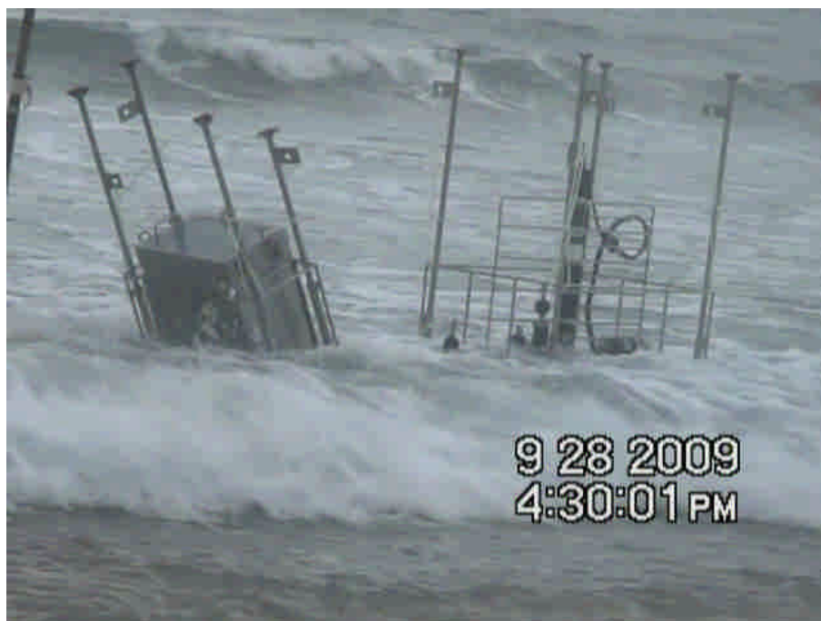
圖 3.25 碎波帶內單純衝擊波通過儀器位置
