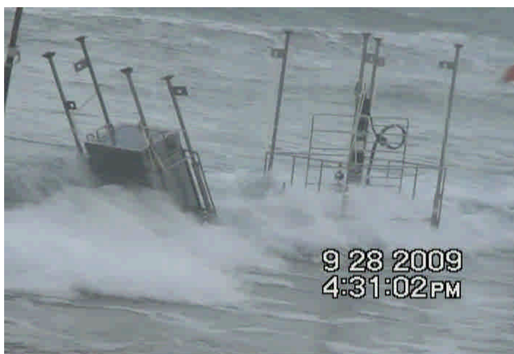
圖 3.26 碎波帶內溢波型二次碎波通過儀器位置
