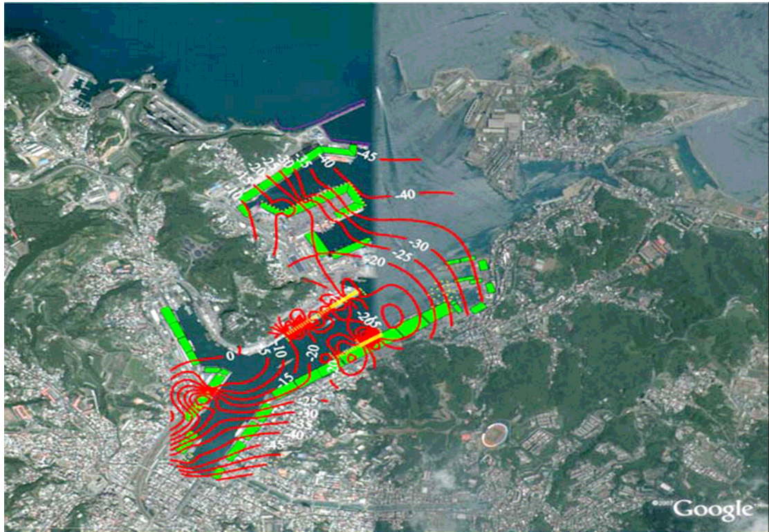
圖3-47 基隆港地區SPT鑽孔基岩高程等值線圖
