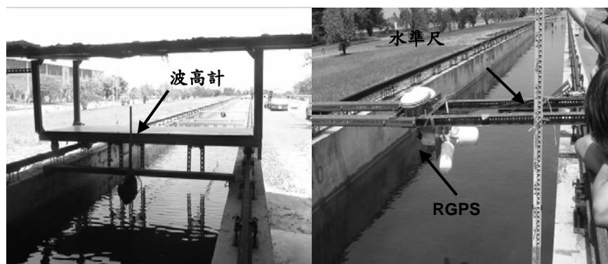
中型斷面水槽進行觀測儀器配置：靜止水面觀測，以及1小時連續下降水位30公分觀測。
