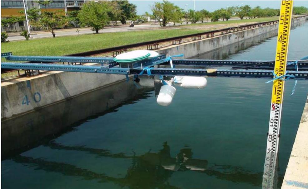
圖 3-5 中型水槽架設 RHCP，LHCP 與水準尺位置
