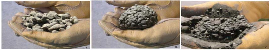
圖 2.1 透水混凝土含水量多寡是否結球行為： (a)太少，(b)適量，(c)太多水 [32]
