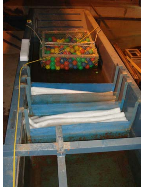
照片 3.3.2 小斷面水槽消波斜坡
