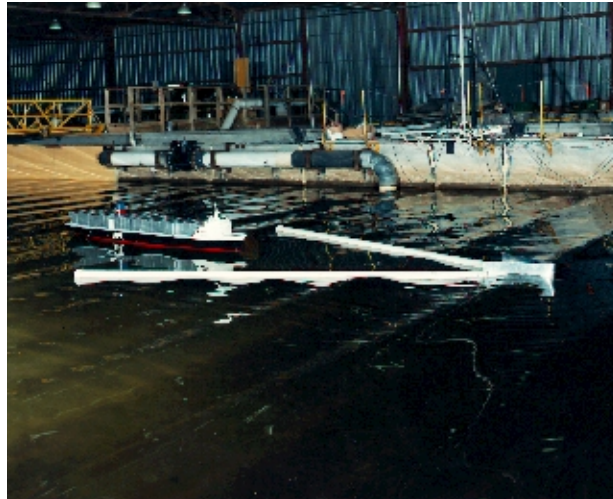
圖 3.1.3 RIBS 水工模型試驗
