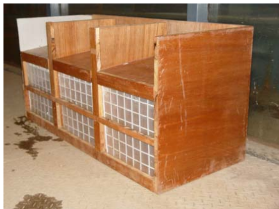
照片 2.5.1 內建斜坡式消能結構物實體模型
