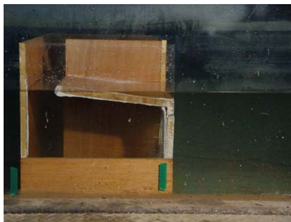
照片 2.5.3 修正之內建斜坡式消能結構物水工模型試驗
