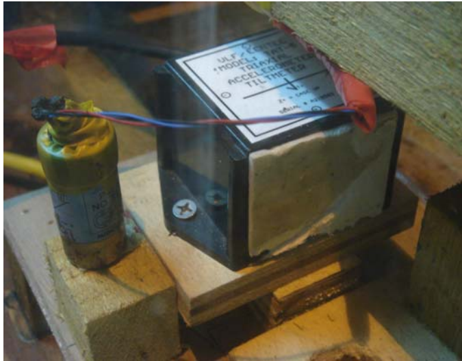
照片 3.3.8 傾角計(左) MOTION SENSOR(右)
