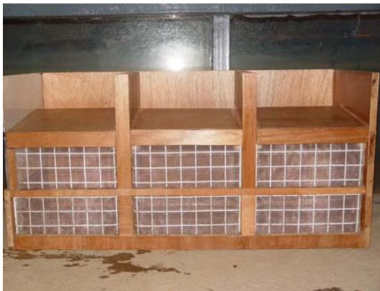
照片 2.5.1 內建斜坡式消能結構物實體模型
