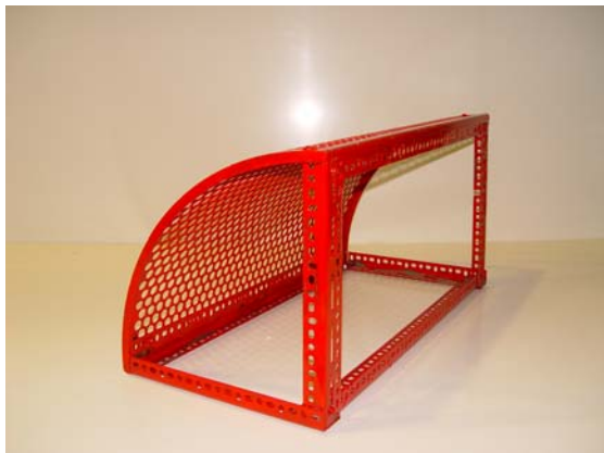
(a) 四分之一圓弧形透水結構物( \epsilon_p = 0.367 ) (將孔隙板 60cm 彎曲成半徑 38.2cm，並利用角鐵支撐)
