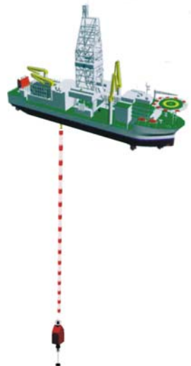
圖 5.7 超短基線聲學定位(SSBL)示意圖
