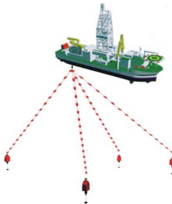
圖 5.5 長基線聲學定位(LBL)示意圖
