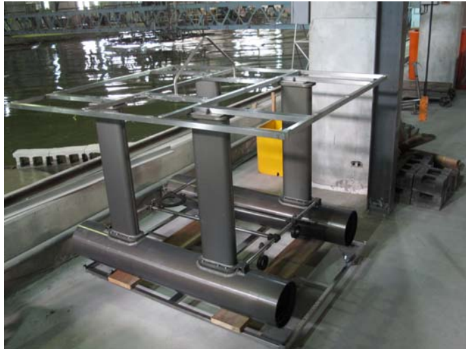
圖 6.3 正進行系統整合測試的無人船體照片
