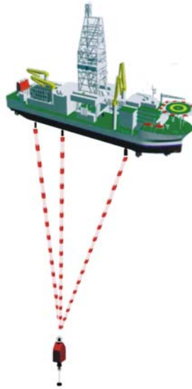
圖 5.6 短基線聲學定位(SBL)示意圖
