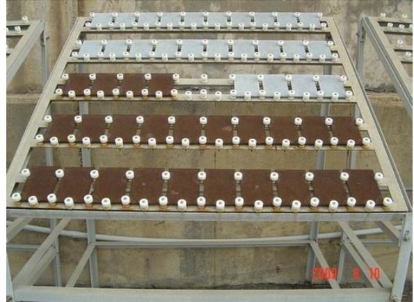
臺中火力電廠鋅材、碳鋼試片
