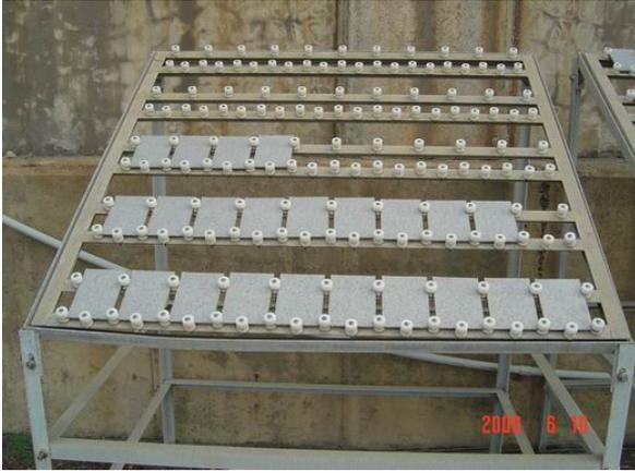
臺中火力電廠鋁材試片(銅試片全數遺失)
