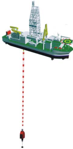
圖 16 超短基線聲學定位(SSBL)示意圖
