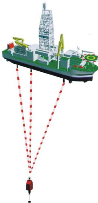
圖 15 短基線聲學定位(SBL)示意圖
