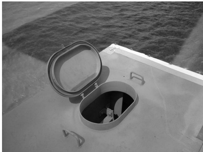
圖 4-23 船舶壓艙水艙人孔道
