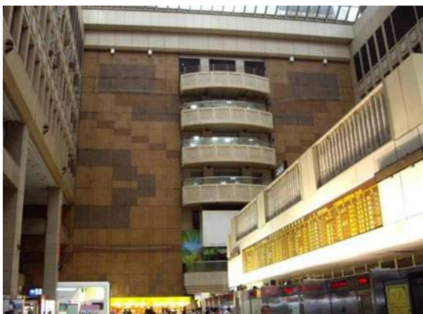
樓地板 >1500\text{m}^2 無法設置平面防火區劃
