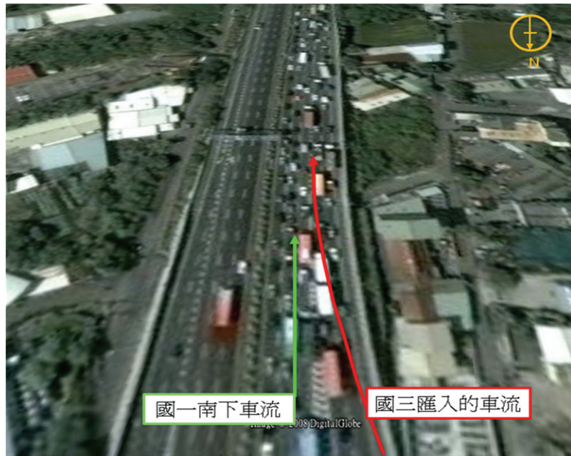
圖 3.2-32 彰化系統路段南下方向壅塞原因示意圖
