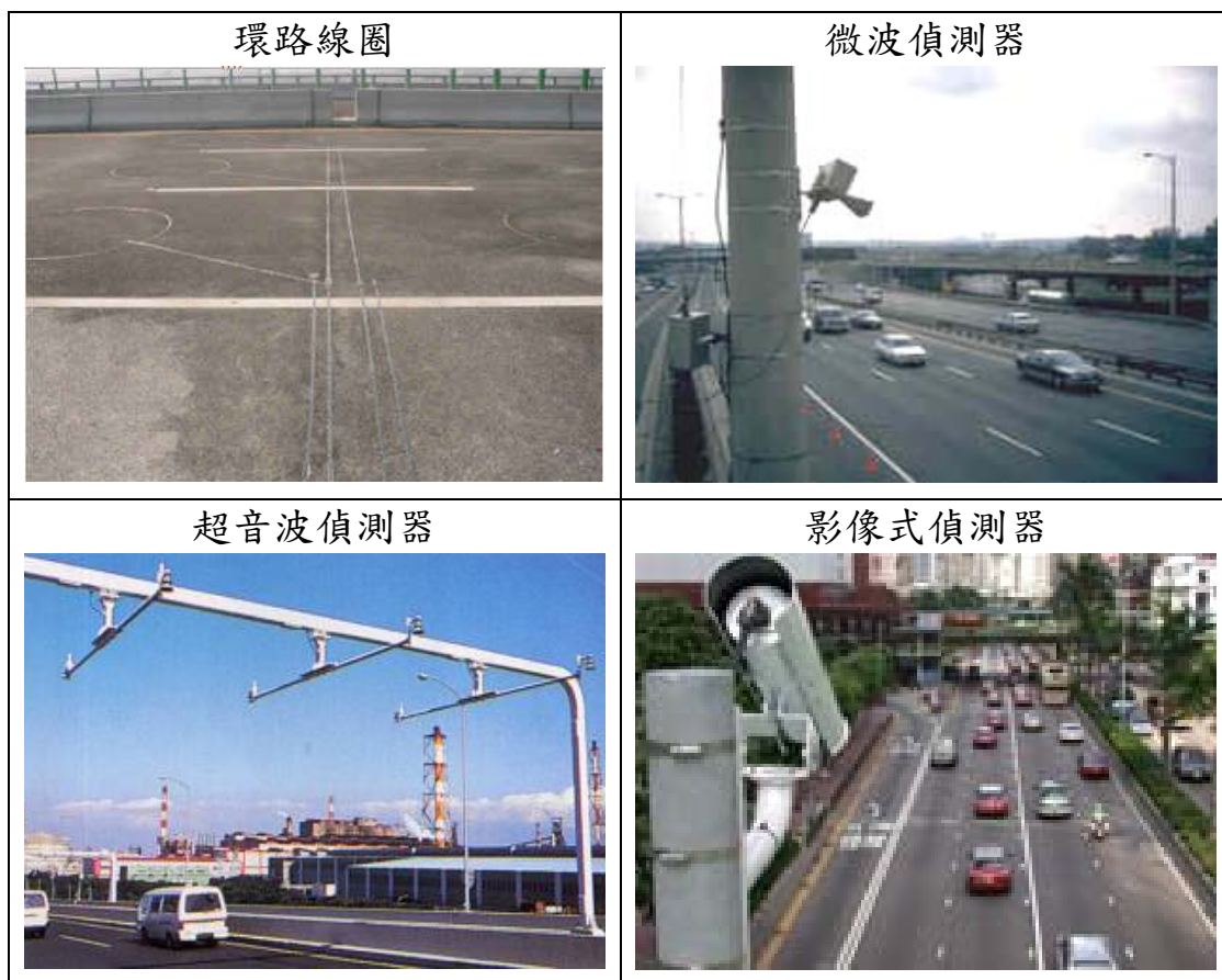
圖 9.1-4 國內所採用 4 種車輛偵測器示意圖
