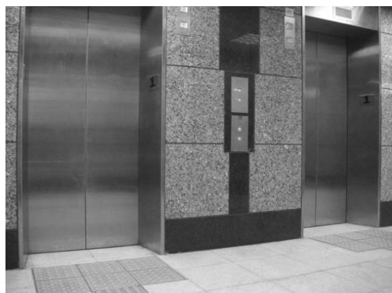
電梯前警示設施位置設置錯誤(板橋車站)
