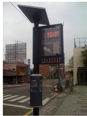
圖 5.22 高鐵路邊太陽能照明及太陽能 LED 公車智慧型站牌
