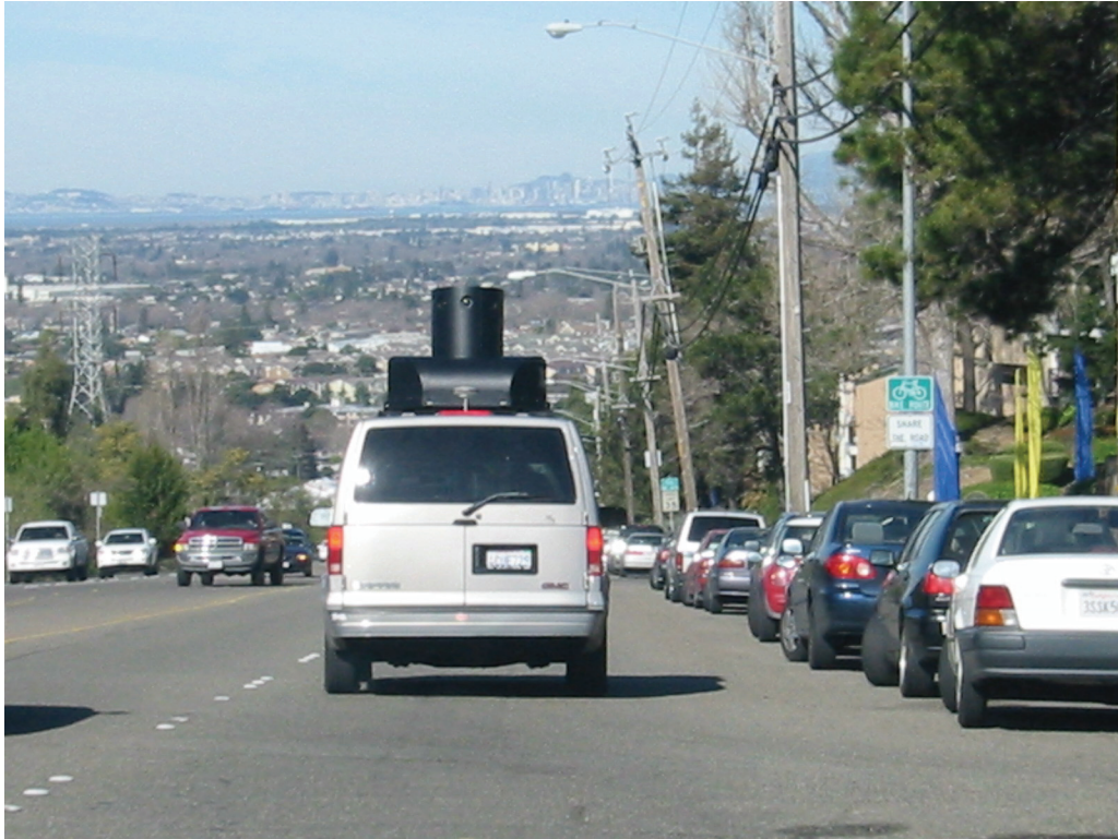
圖 2. 49 Google Street View 行動製圖車 I [43]
