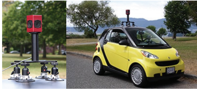
圖 3.49 全景球面視覺系統安裝方式
