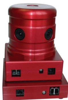
圖 3. 47 全景球面視覺系統-瓢蟲 2 球面數位攝影機
