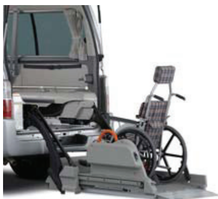
圖 3-2 日本 8~10 人座車輛輪椅昇降台 [1]
