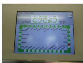
圖 5- 163 JR 東日本山手線車內 LCD 電子顯示器(c)(本研究拍攝)
