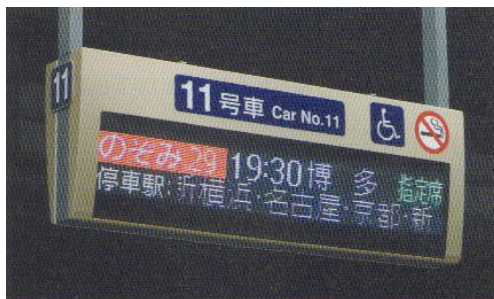
圖 5- 95 全彩雙列 LED 資訊系統(日本) 圖 5- 96 全彩單列 LED 資訊系統(日本) [40]
