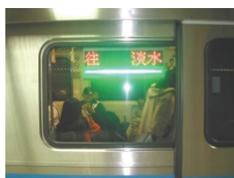
圖 5- 158 臺北捷運車側目的地 LED 電子顯示器(本研究拍攝)
