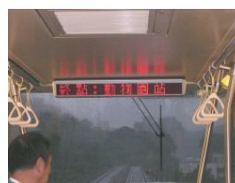
圖 5- 159 臺北捷運車內 LED 電子顯示器(本研究拍攝)
