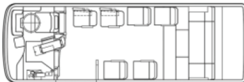
圖 3-28 日本低底盤小型客運車輛上視圖 [31]
