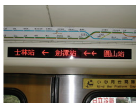
圖 5- 160 臺北捷運車內路線識別 LED 電子顯示器(本研究拍攝)
