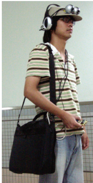
圖 7-9 視障者輔具系統使用外觀圖 [67]
