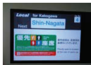
圖 5- 157 JR 西日本 321 系列車內 LCD 電子顯示器 [40]
