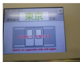
圖 5- 162 JR 東日本山手線車內 LCD 電子顯示器(b)(本研究拍攝)
