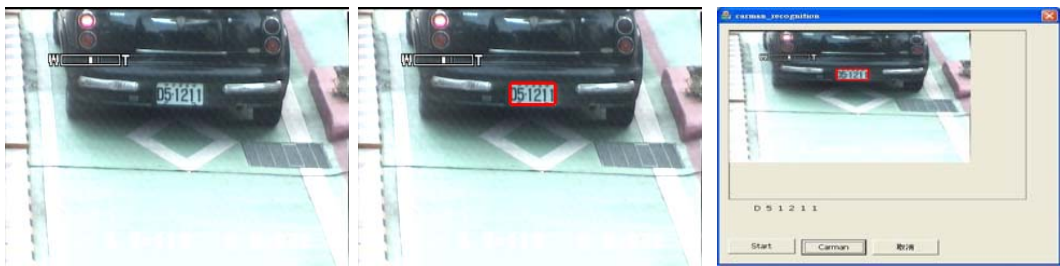
(a)鎖定違規停車 (b)偵測車牌位置 (c)辨識車號
