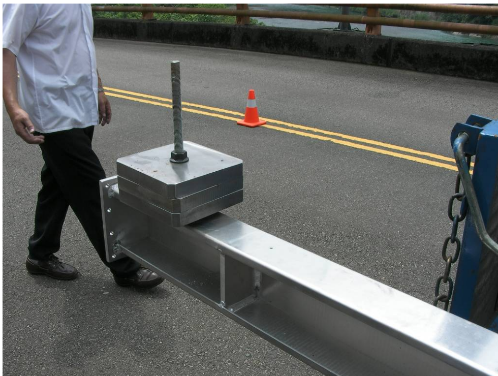
圖 4.7 機械手臂第 3 臂安裝平衡配重塊
