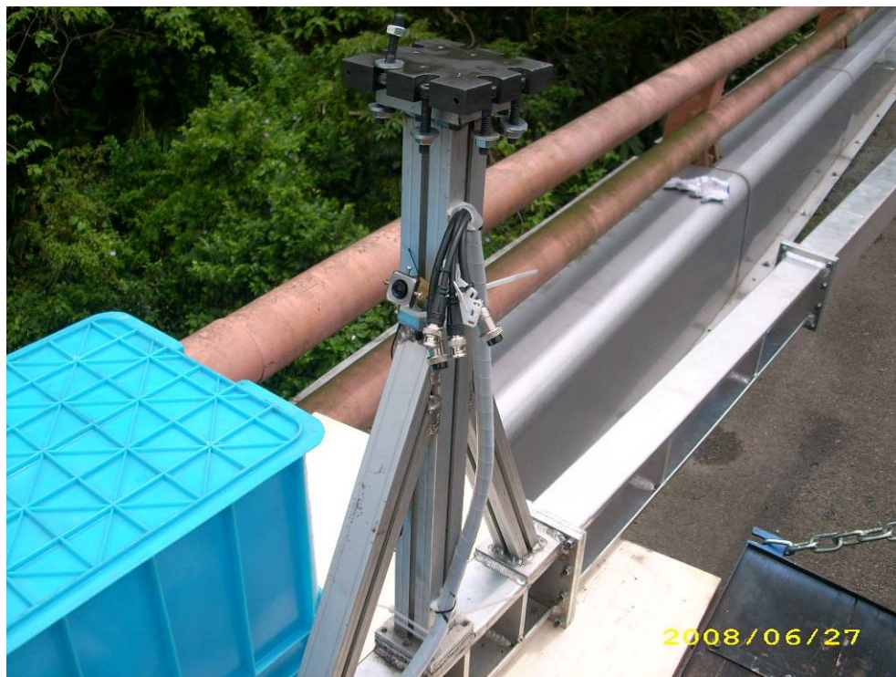
圖 4.14 檢測車機械手臂第 2 臂與第 3 臂接合之快速接頭及工作平台
