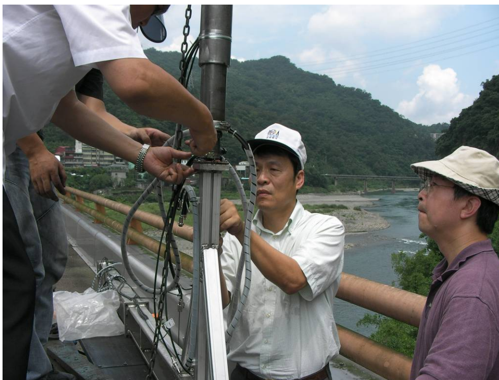
圖 4.5 機械手臂第 2 臂與第 3 臂接合
