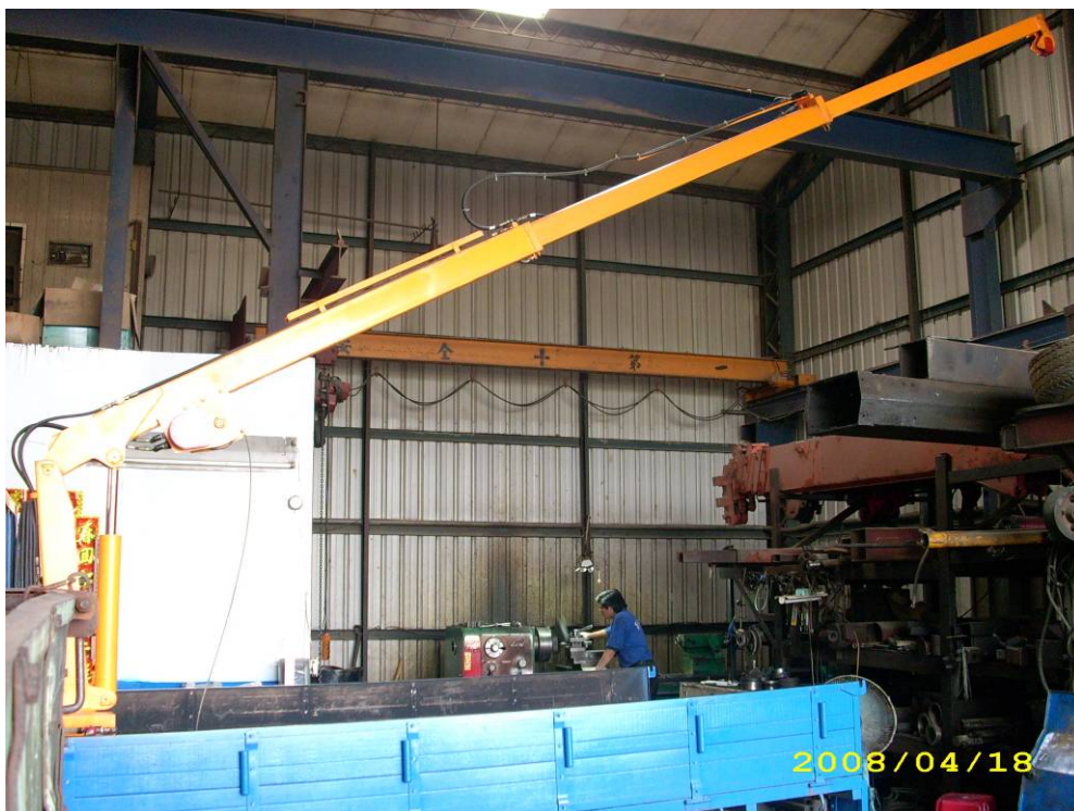
圖 3.10 機械手臂第 1 臂油壓吊桿之測試
