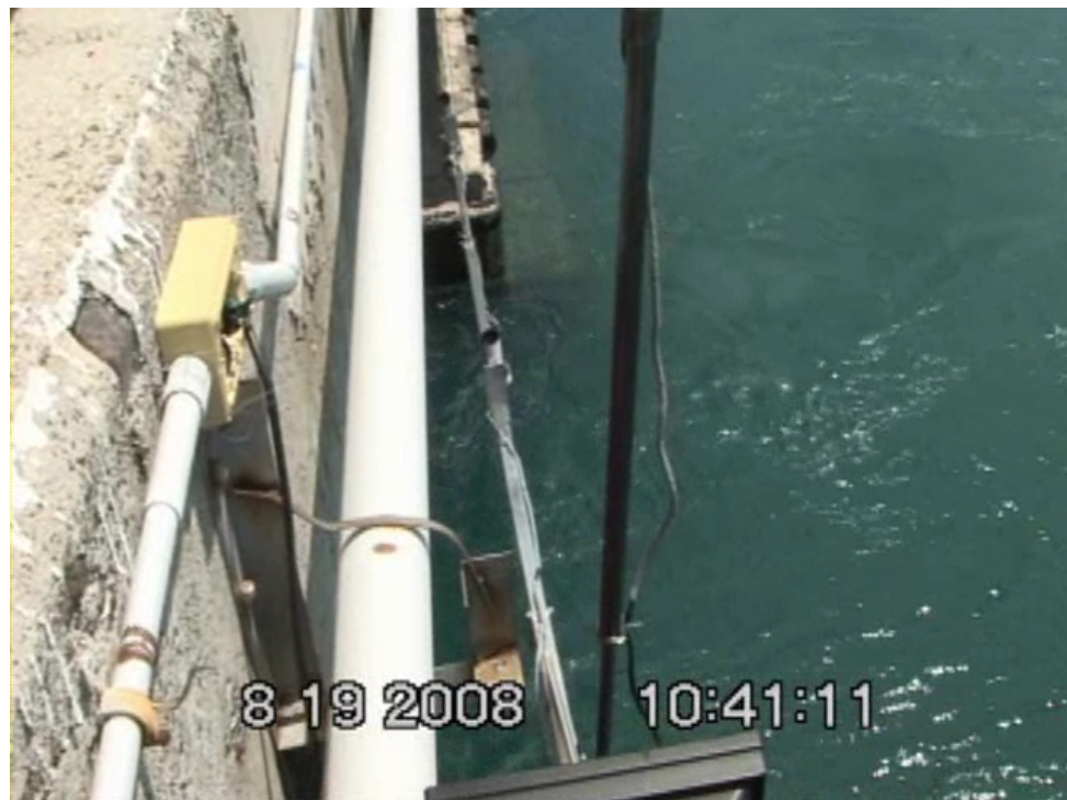
圖 4.26 操控第 3 臂下降至預定深度
