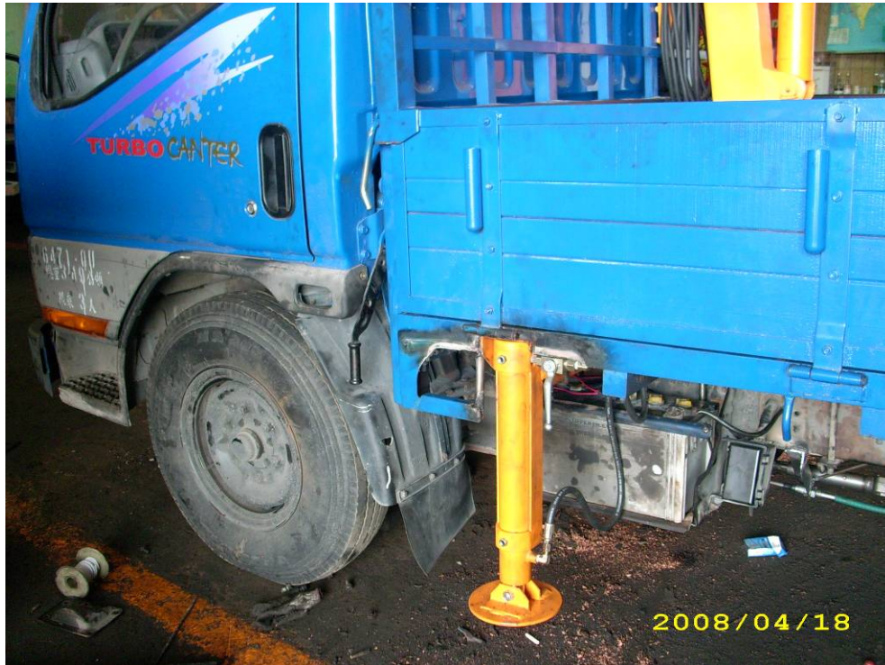
圖 3.9 檢測車油壓支撐腳之加工
