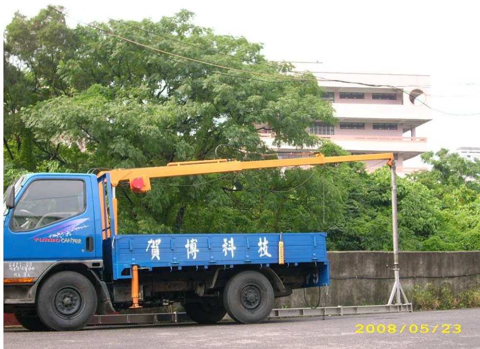
圖 3.14 機械手臂全臂吊重之結構強度及操控(河堤邊測試)(1)
