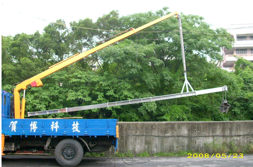
圖 3.15 機械手臂全臂吊重之結構強度及操控(河堤邊測試)(2)
