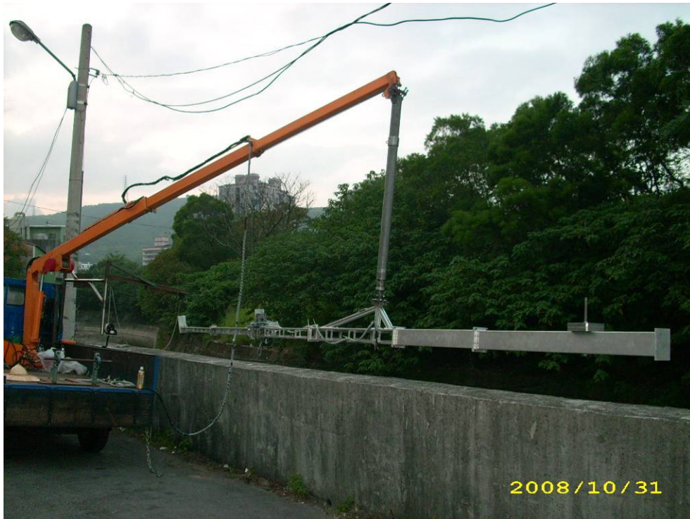
圖 4.35 附加配重塊之第 3 臂跨越橋護欄並與之平行
