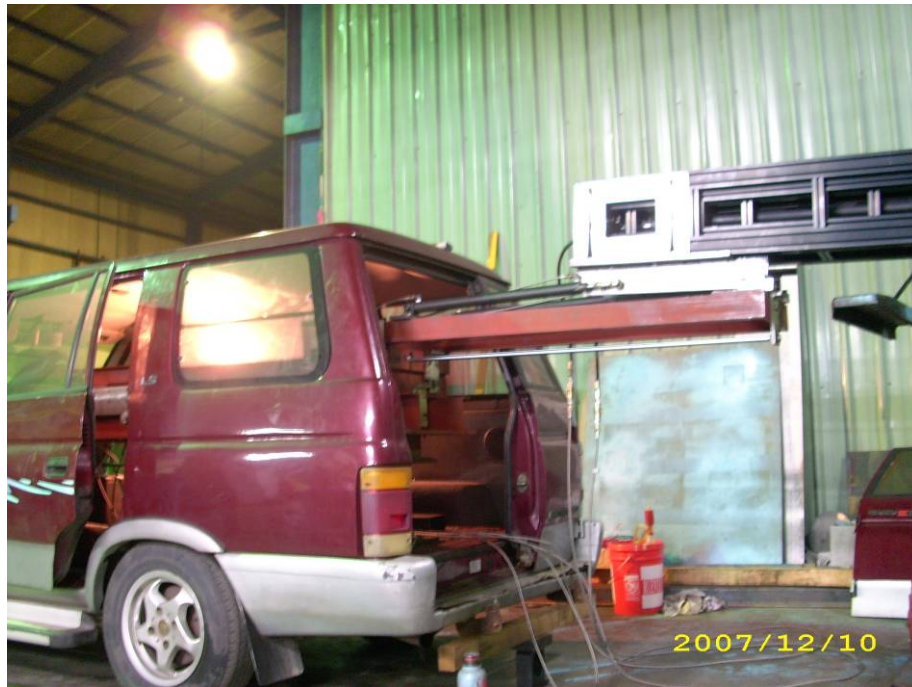
圖 2.5 機械手臂組裝後油壓推進測試
