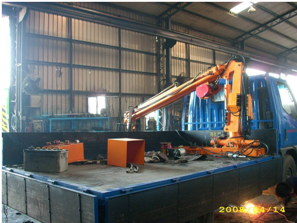
圖 3.8 機械手臂第 1 臂油壓吊桿之加工
