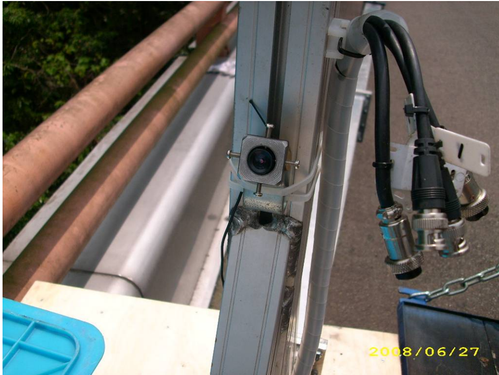
圖 4.15 機械手臂第 3 臂附加之小型攝影機
