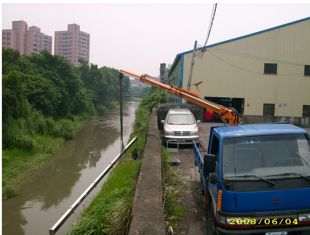
圖 3.16 機械手臂全臂吊重之結構強度及操控(河堤邊測試)(3)
