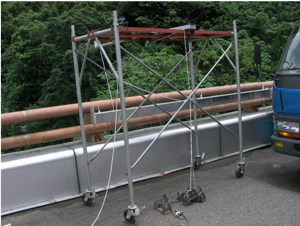
圖 4.16 吊掛第 3 臂末端保持平衡之機構
