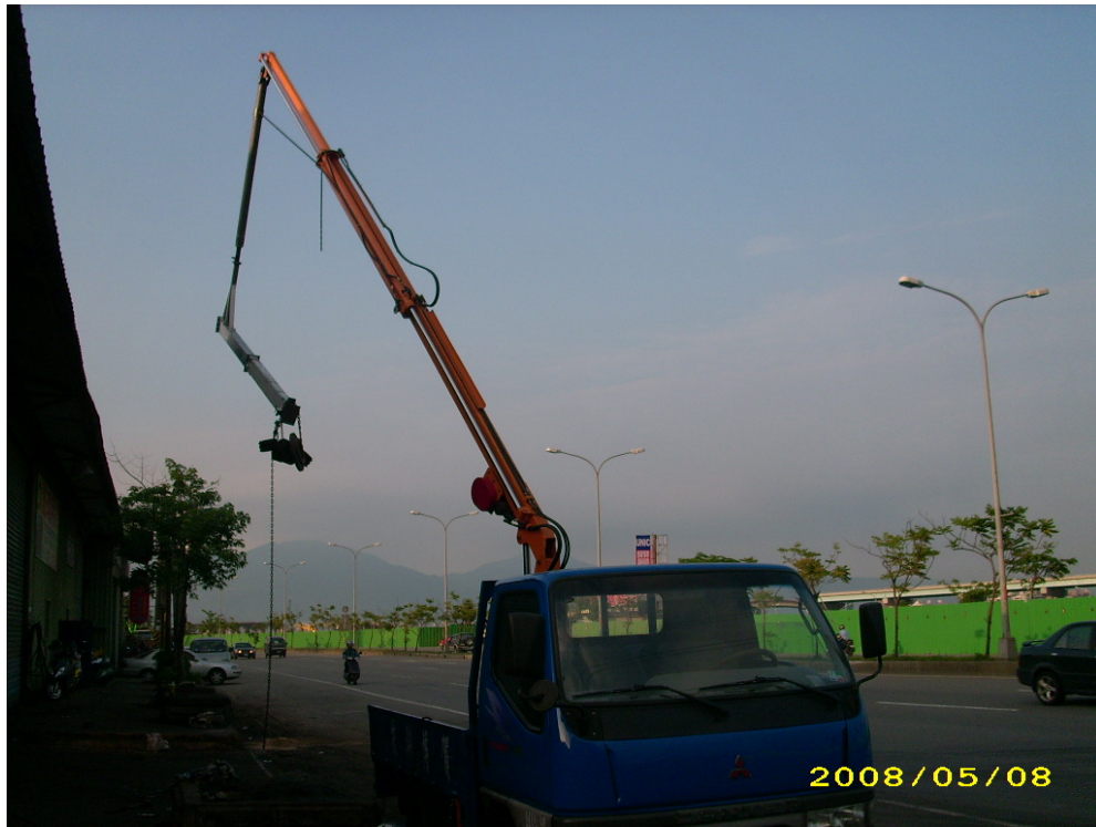
圖 3.13 機械手臂全臂吊重之結構強度及操控(室外測試)
