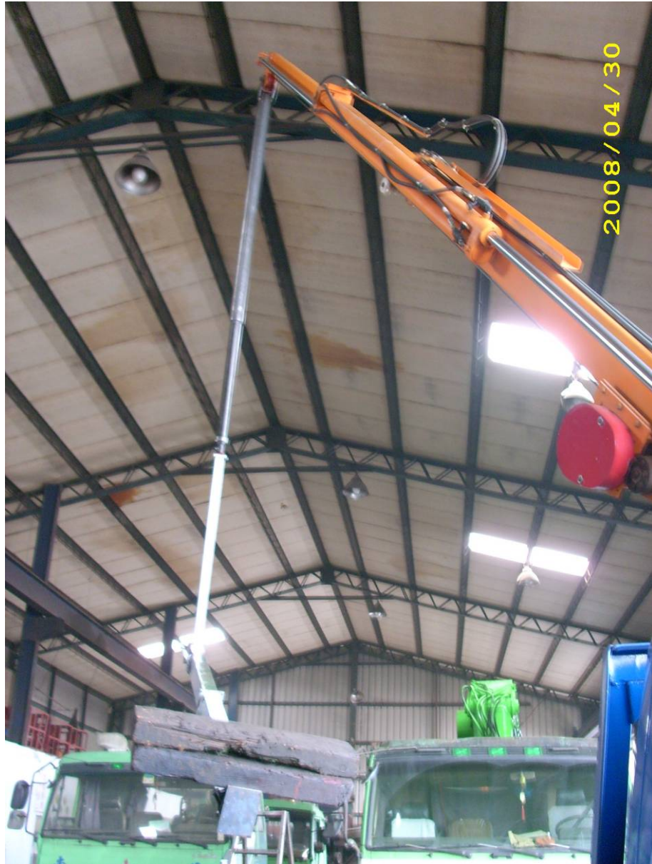
圖 3.12 機械手臂全臂吊重之結構強度及操控(室內測試)
