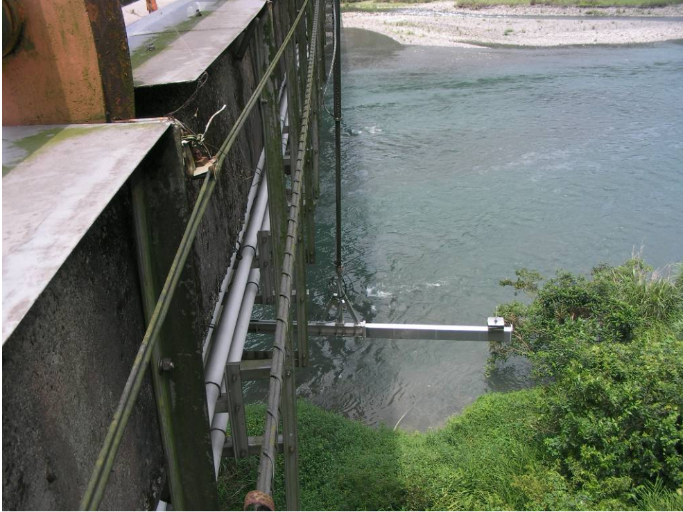
圖 4.11 機械手臂附載之攝影機深入橋面下
