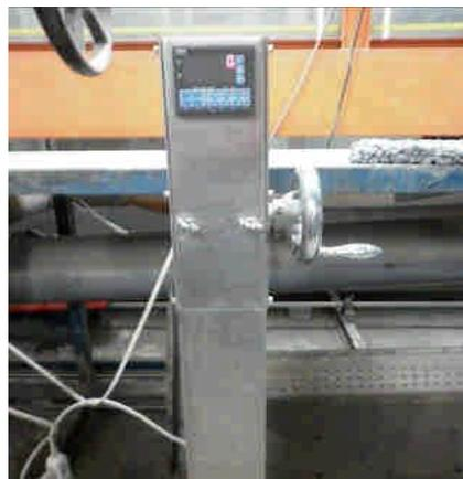
照片 8 顯示式管路手動矩形閘閥照片
