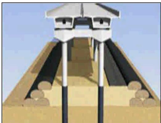
圖 3 韓國仁川跨海大橋砂腸管配置示意圖(盟鑫工業股份有限公司)
