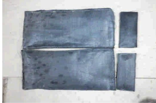
照片 5 砂腸袋工法模型照片
