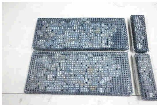
照片 4 格籠工法模型照片
