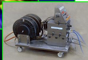
電弧常溫金屬熔射
