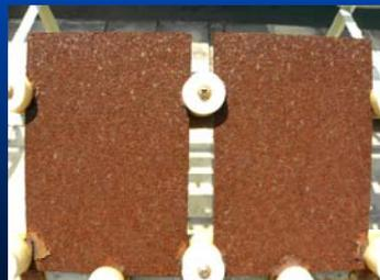
碳鋼-表面為暗紅色顆粒狀鬆散的腐蝕生成物，邊緣並有分層剝離的現象
