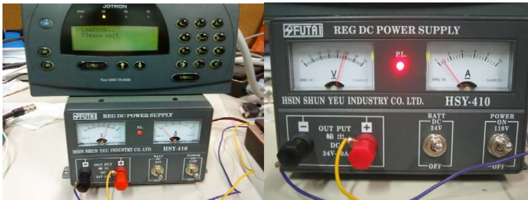
圖4.5 AIS運作所需功率之量測
