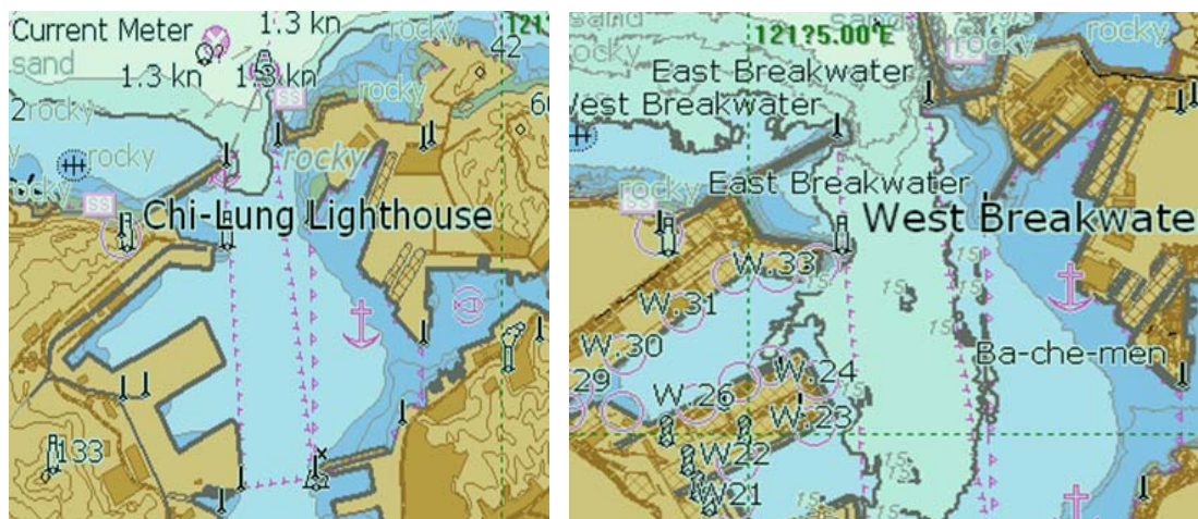
圖 4-1 ENC 內等深線間隔對 ECDIS 防擱淺顯示功能的影響：
