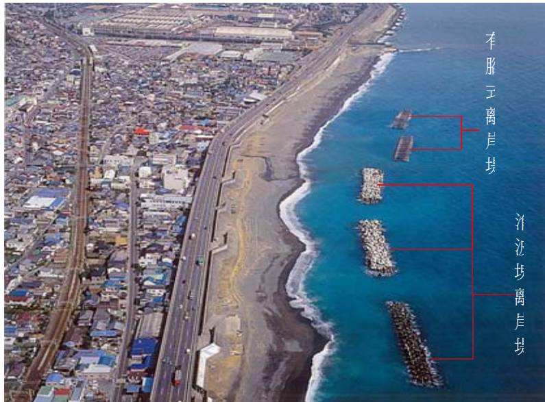
圖 6.37 有腳式離岸堤能維持自然的海岸線 (資料來源:日本國土交通省地方整備局靜岡工務所)
