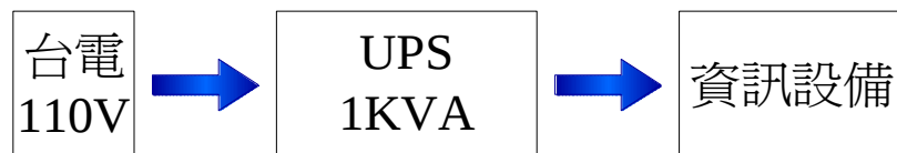
圖 3.10 現勘段電力供應流程
