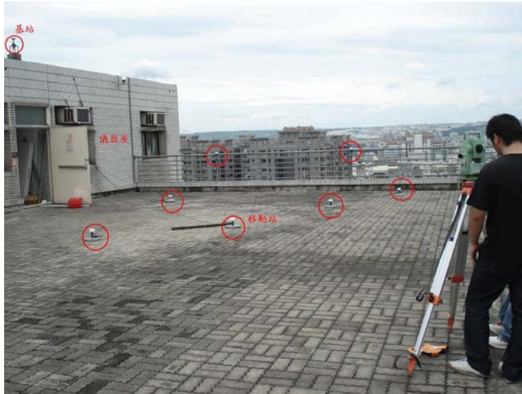
圖 5.2 多天線 GPS 試驗配置圖
