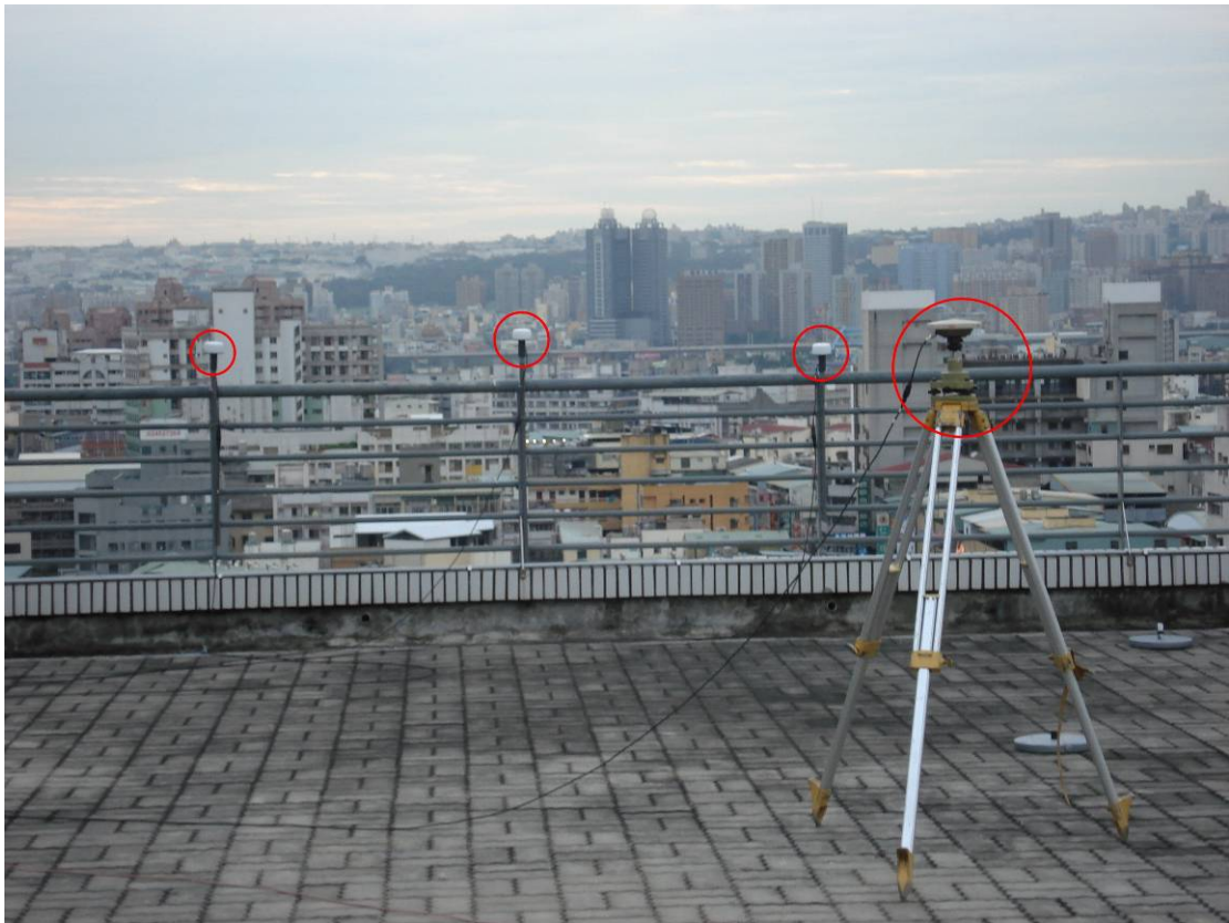
圖 5.6 修改後多天線 GPS 位置配置圖
