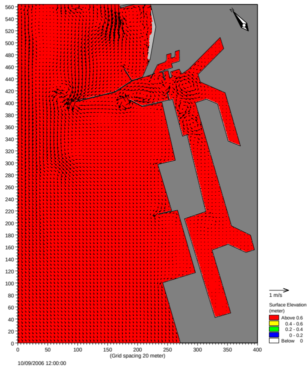
圖 5-3 夏季季風( H_s=0.9\text{m} ， T_s=5.3\text{sec} ，W 向)流場分布圖(興建定沙突堤及延長攔沙堤配置)
