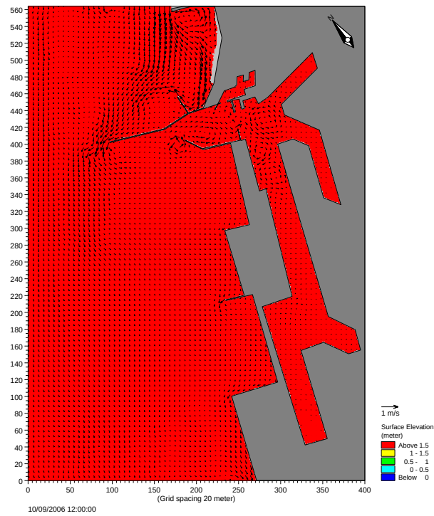
圖 5-2 冬季季風( H_s=2.1\text{m} ， T_s=5.6\text{sec} ，N 向)流場分布圖(興建定沙突堤及延長攔沙堤配置)
