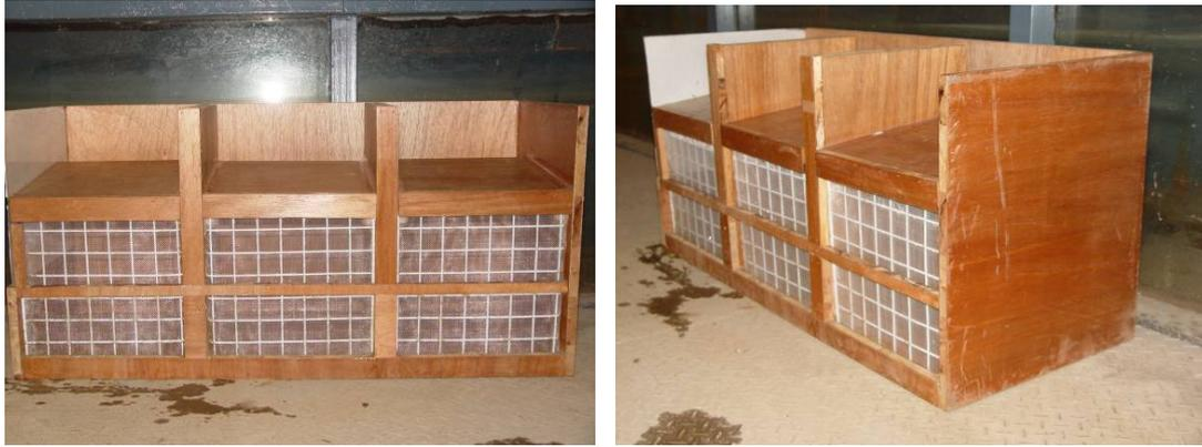
照片 2.4.1 內建斜坡式消能結構物實體模型
