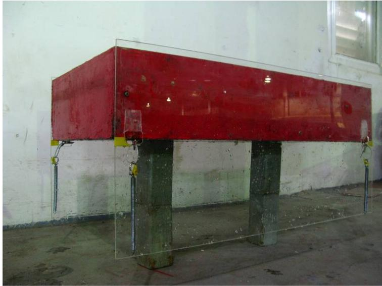
照片 3.3.10 刚性翼板繫留浮體模型(0 度 25 公分)
