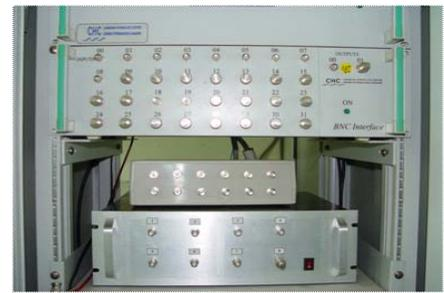
(d) 造波系統及波高擷取系統
