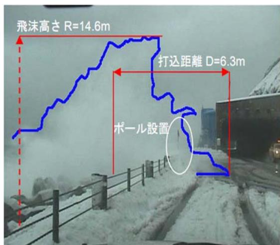
圖 5.5.1 海岸道路越波捕捉面
