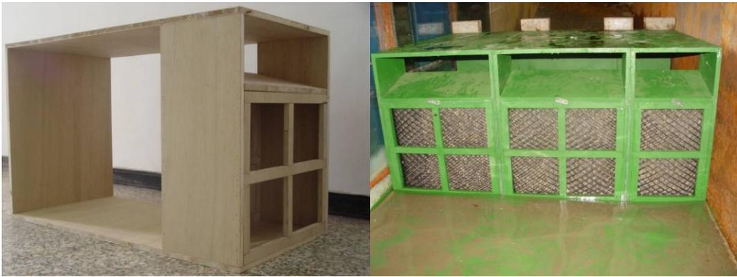
照片 2.4.6 長波抗浪型斷面試驗模型完工與設置
