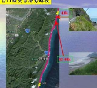
此段有設置新機隧道，但因地質多為礫岩土，加上離海近，路基易被海岸侵蝕淘刷，進而產生崩塌。目前四工處已將此段內縮100m，現今仍在施工中。
