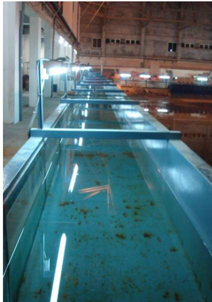
照片 3.3.1 斷面造波水槽
