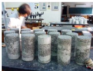
照片4-25 試體有垂流阻塞孔隙現象
