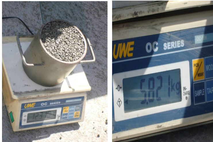
照片 4.7 拌合廠測量新拌透水混凝土單位重( 1,836 \text{ kg/m}^3 )
