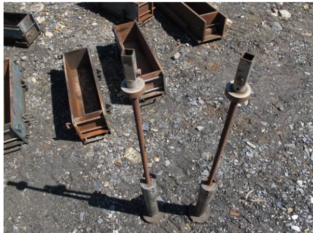
照片 4.23 透水混凝土試體模具與夯實用之搗棒
