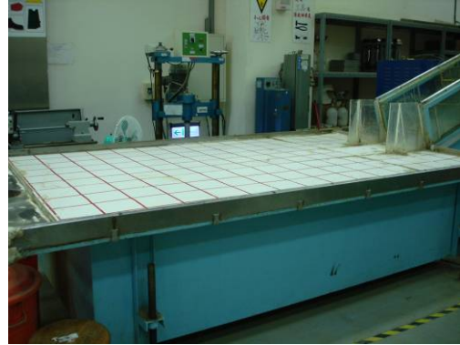
照片 6.7 土石流儀堆積盤
