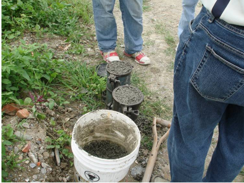
照片 3.10 透水混凝土圓柱抗壓試體之製作。
