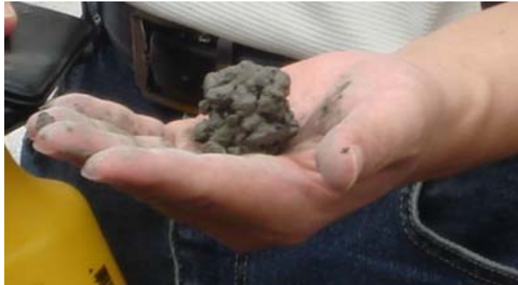
照片 3.6 新拌透水混凝土無垂流之現象
