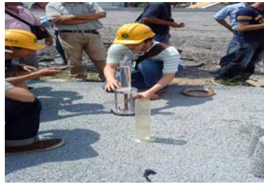
透水混凝土鋪面透水試驗
