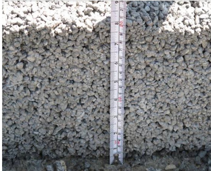
照片 4.27 鋪設厚度符合設計厚度
