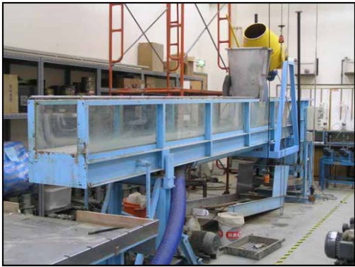
照片 6.6 土石流水道主體
