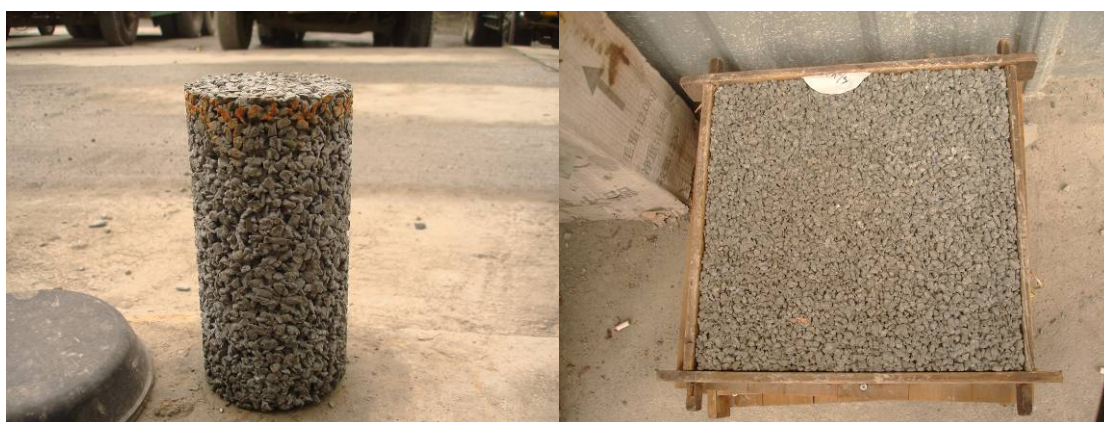
照片 3.1 透水混凝土試樣(圓柱與版)扁平率過高
