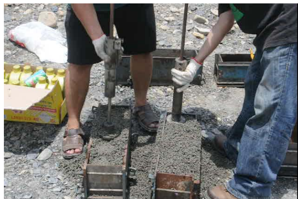
照片 4.24 搗棒夯實製作透水混凝土試體之情形
