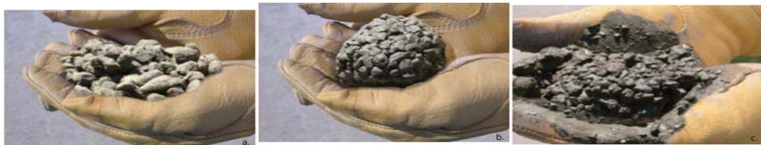
圖 2.1 透水混凝土含水量多寡是否結球行為：
