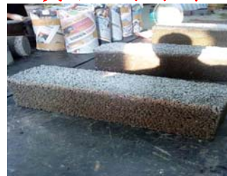
照片4-26 抗彎試體外觀
