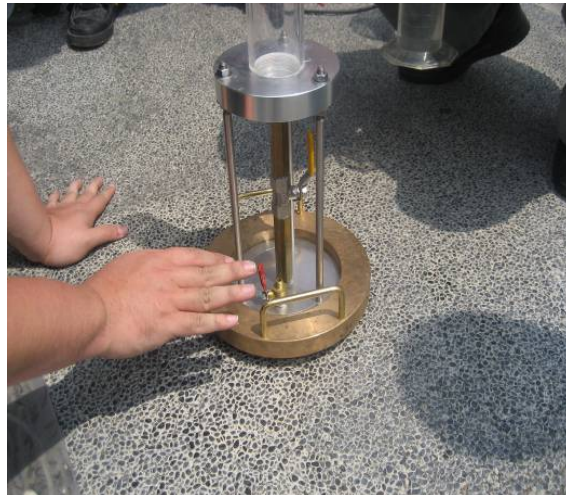
照片 5.13 現場透水試驗儀器
