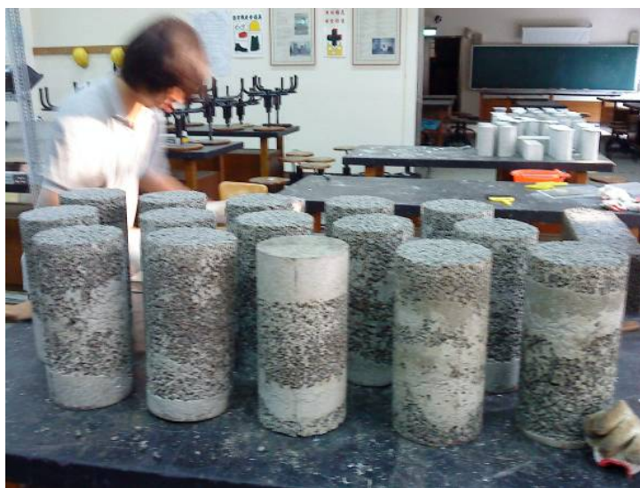
照片 4.25 試体部分有垂流阻塞孔隙現象
