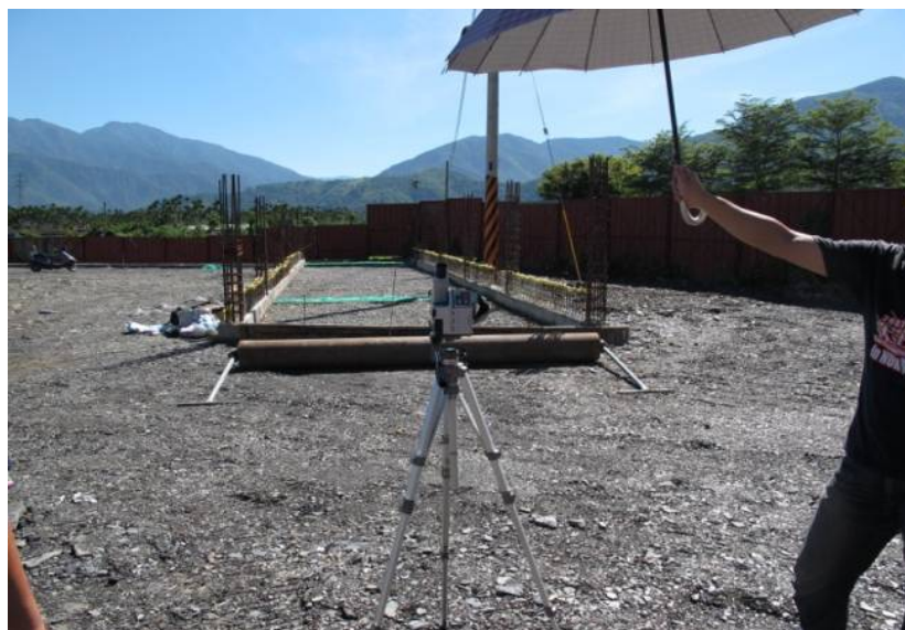
照片 4.9 紅外線溫度監測
