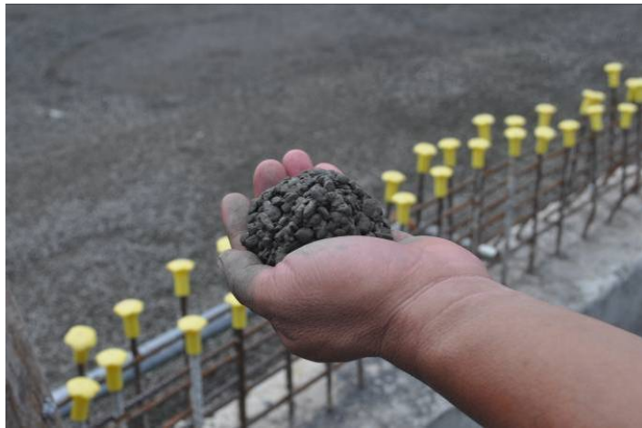
照片 4.10 新拌透水混凝土無垂流之現象
