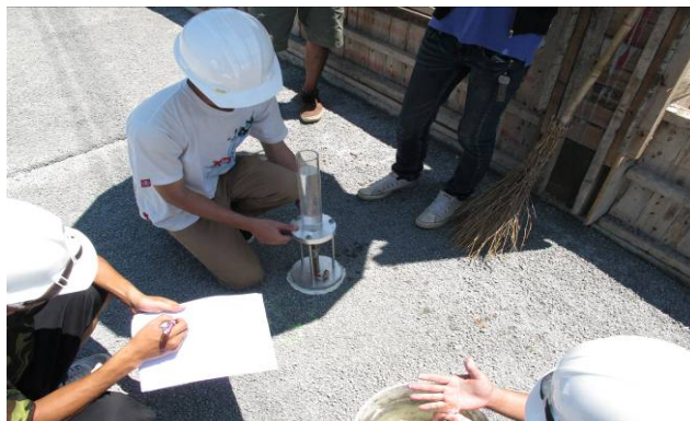
照片 5.14 現地透水試驗水位下降前
