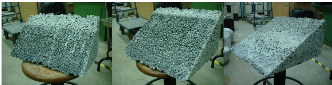
照片 6.17 透水混凝土海堤模型：(a)坡度 1:1，(b)坡度 1:1.5， (c) 坡度 1:2
