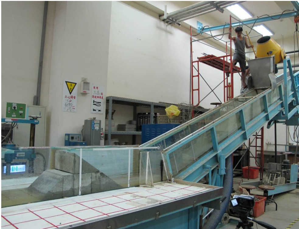
照片 6.15 溯升試驗儀器架設法
