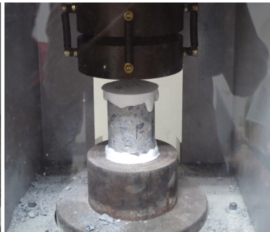
圖 3.11 試體抗壓試驗及破裂狀態
