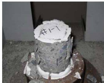
圖3-7 試體抗壓試驗 及破裂狀態
