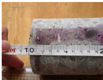
圖3-8鑽心試體 中性化情形
