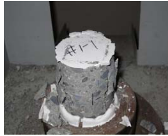
圖3-7試體抗壓試驗及破裂狀態
