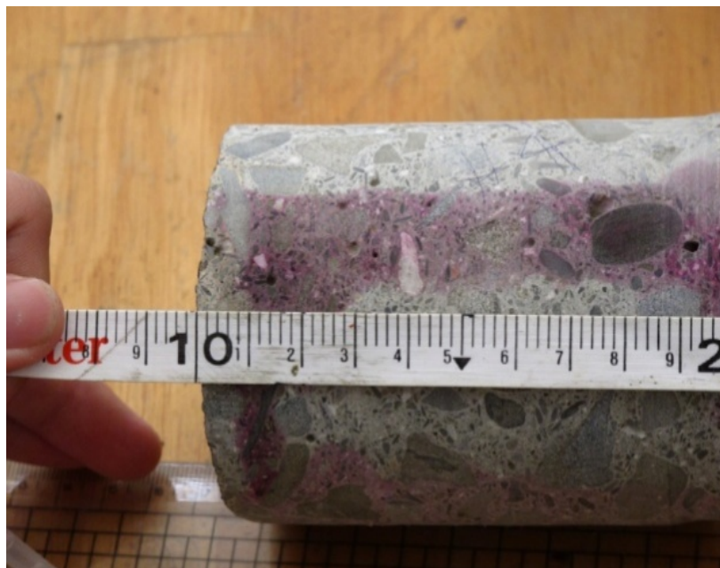
圖 3.12 鑽心試體中性化情形
