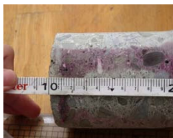
圖3-8鑽心試體中性化情形
