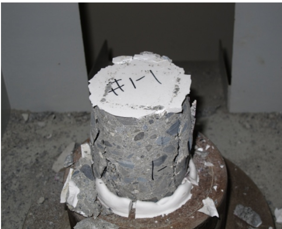
圖 3.11 試體抗壓試驗及破裂狀態
