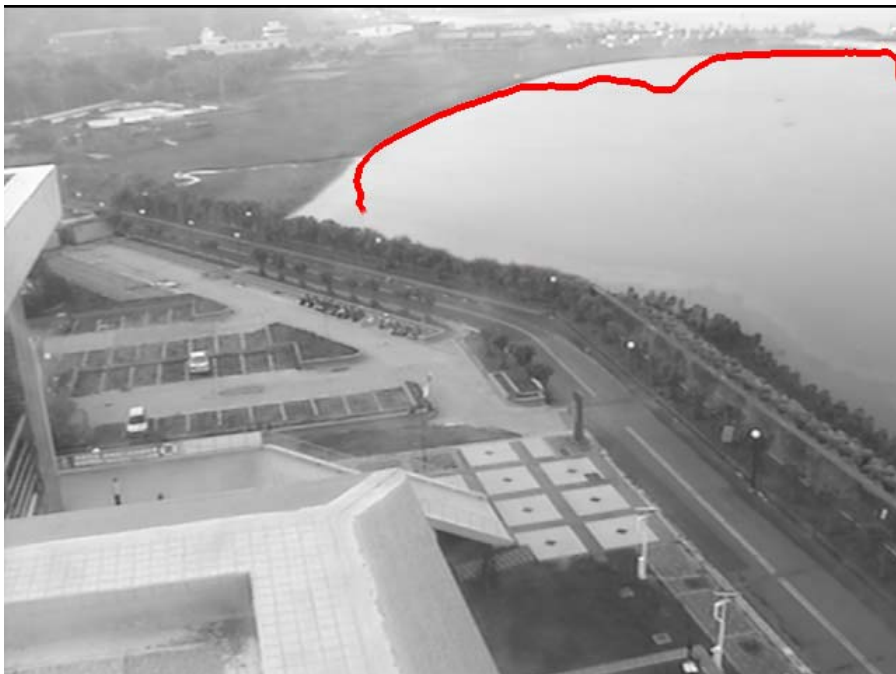
圖 3.3.2A 疊代 200 次之輪廓曲線 (西子灣平均影像,方位角 1000, 2010/05/01, 06:00 a.m.)
