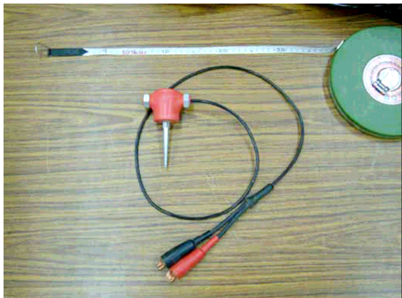
圖 3.15 高感度電磁式速度受波器(4.5Hz)
