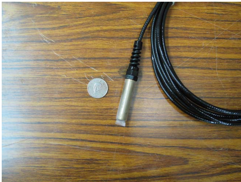
圖 3.17 Geometrics 公司製造型號為 23464-01 之觸發器
