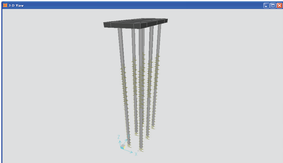
圖 6.6 直樁棧橋式碼頭 SAP2000 模型及土壤彈簧示意圖
