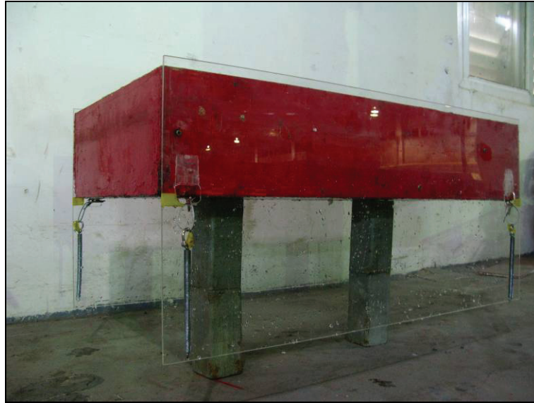
照片 3.1.2 剛性翼板繫留浮體模型(0 度 25 公分)
