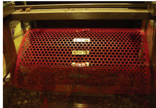
照片 4.2.1 水工模型圓弧板上壓力計安裝照片
