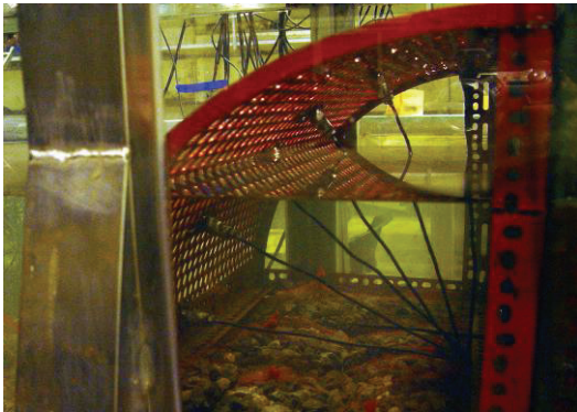
照片 4.2.1 水工模型圓弧板上壓力計安裝照片
