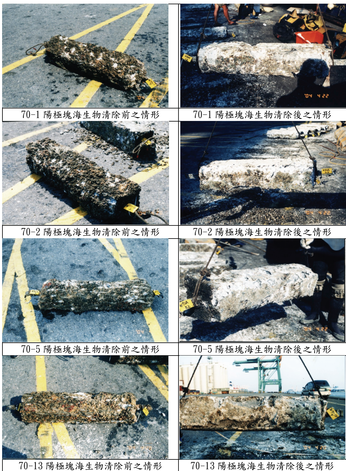
圖 2.23 高雄港 70 號碼頭陽極塊海生物清除前後之情形
