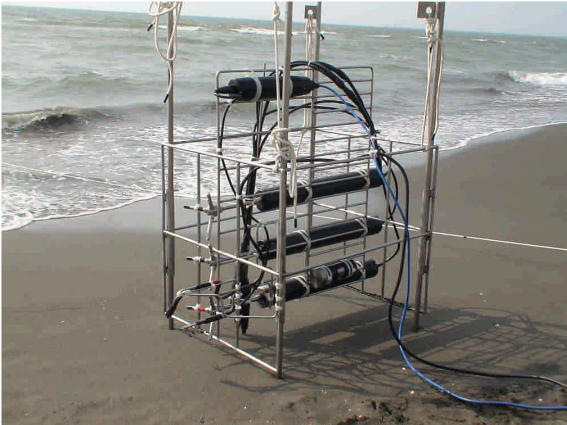
圖 1.4 現場儀器下水前固定於儀器架上情形
