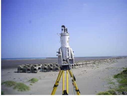
照片 3-1 Lidar 地形測量情形
