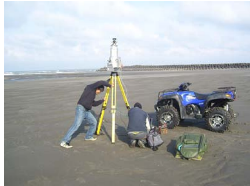
照片 3-1 Lidar 地形測量情形
