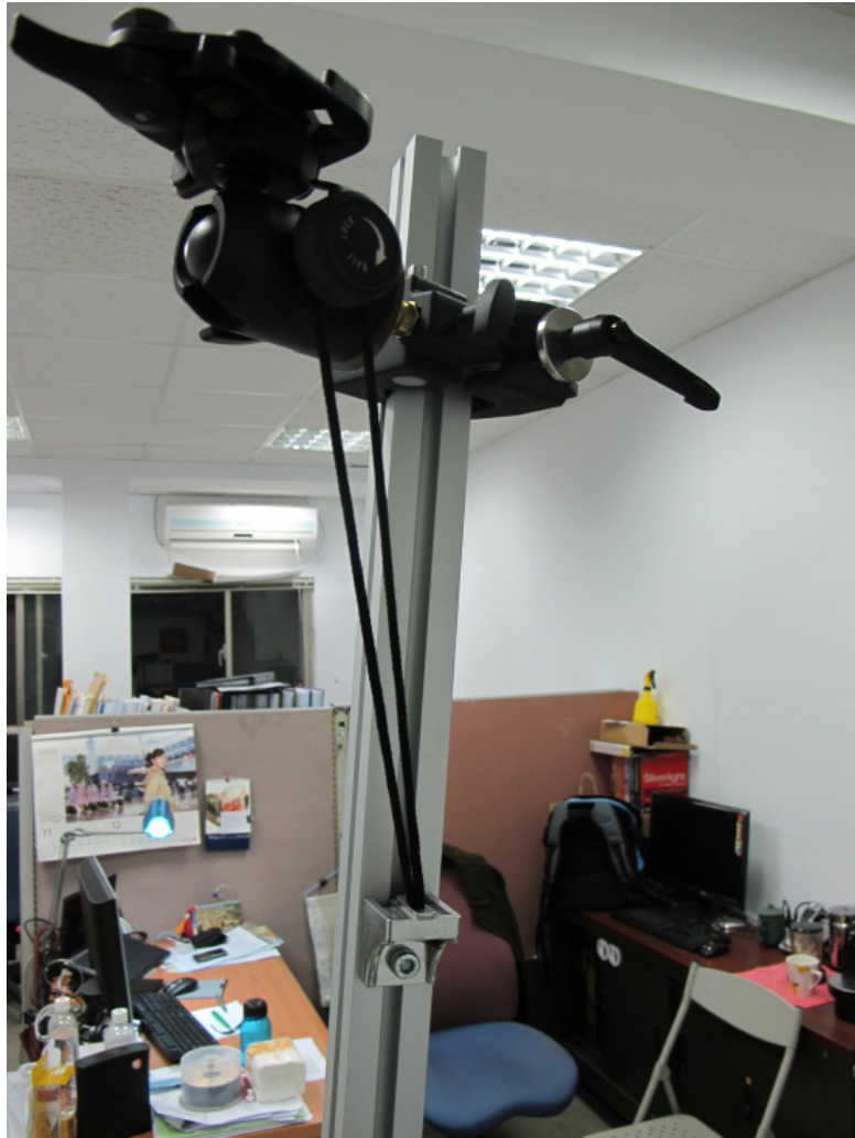
圖2.23 第二代 雲台會有翻落的情形因此拉線固定
