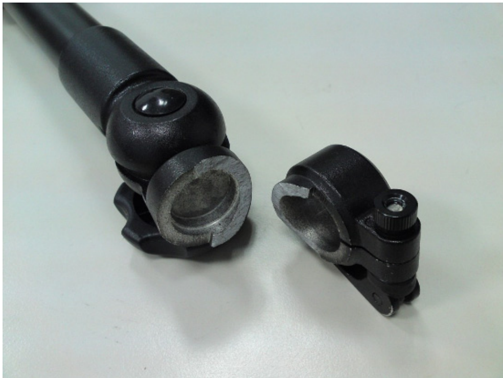
圖2.18 第一代 腳架斷裂
