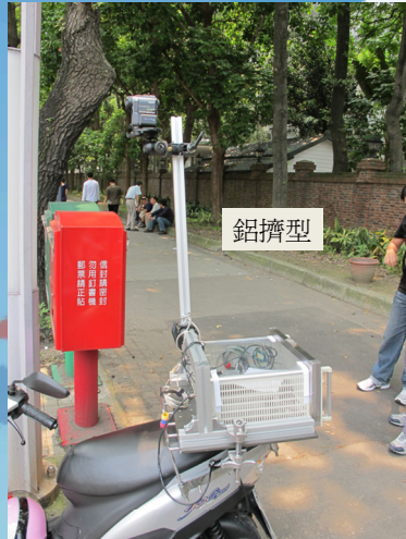
透明壓克力蓋板，小筆電過熱當機
