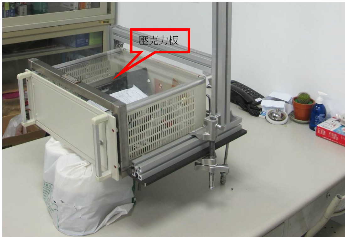
圖2.21 第二代 主機箱蓋板改用透明壓克力板
