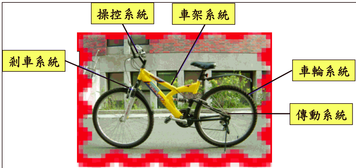
圖 2.1-1 自行車基本構造圖
