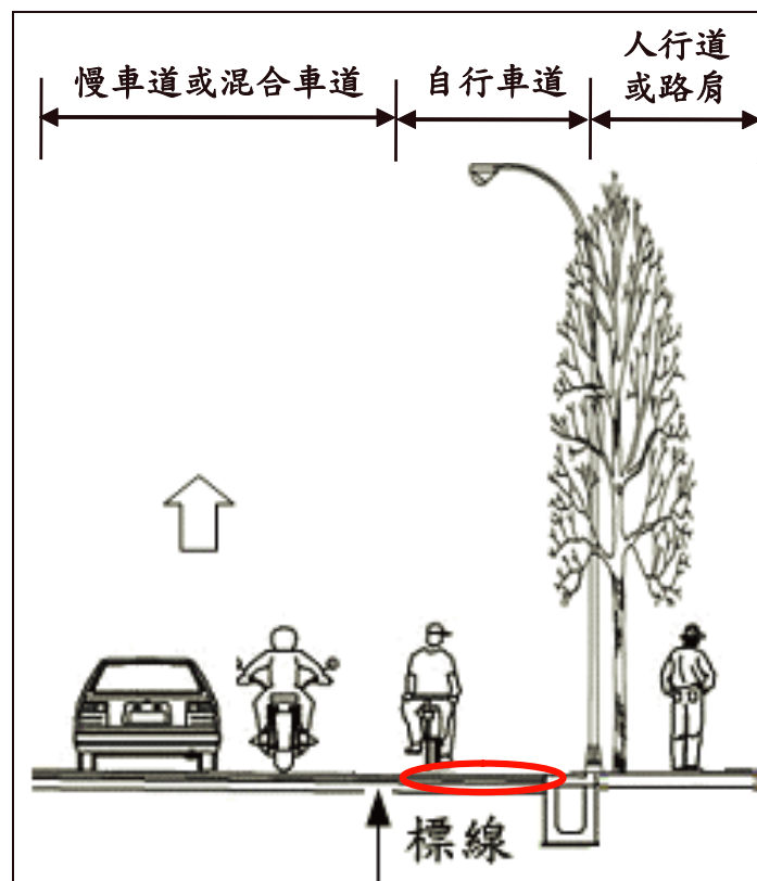
圖 3.8 於車道的外側設置以單白實線分隔之自行車道 (Type9)
