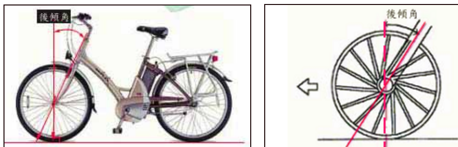
圖 2.2-2 自行車の後傾角
