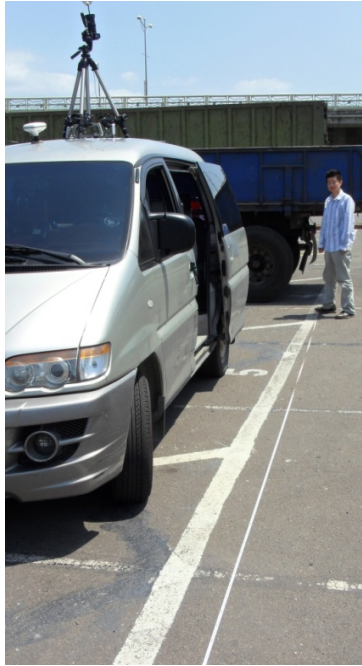
圖 4-19 環景設備固定於車頂情形
