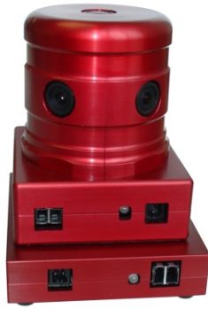
圖 4-4 全景球面視覺系統-瓢蟲 2 球面數位攝影機
