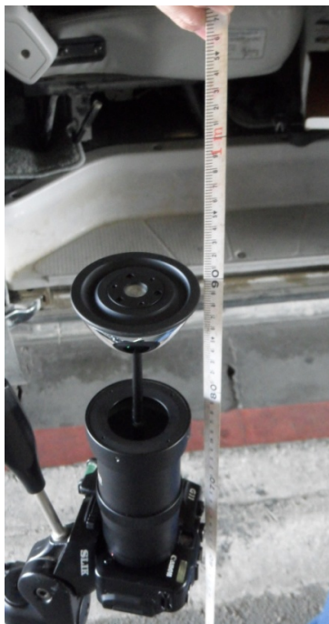
圖 4-20 環景鏡頭架設高度
