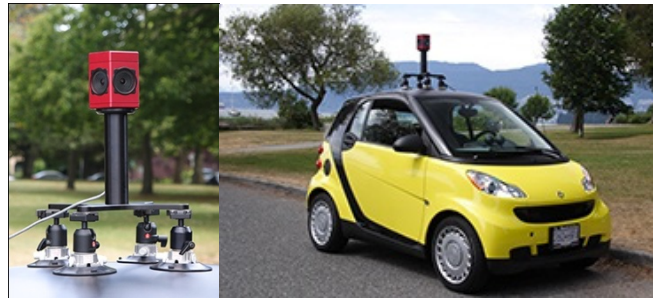
圖 4- 17 全景球面視覺系統安裝方式
