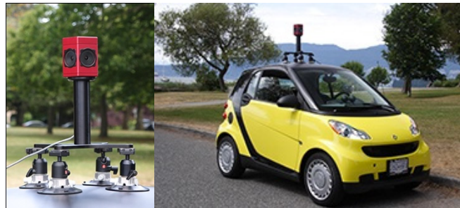
圖 4-6 全景球面視覺系統安裝方式
