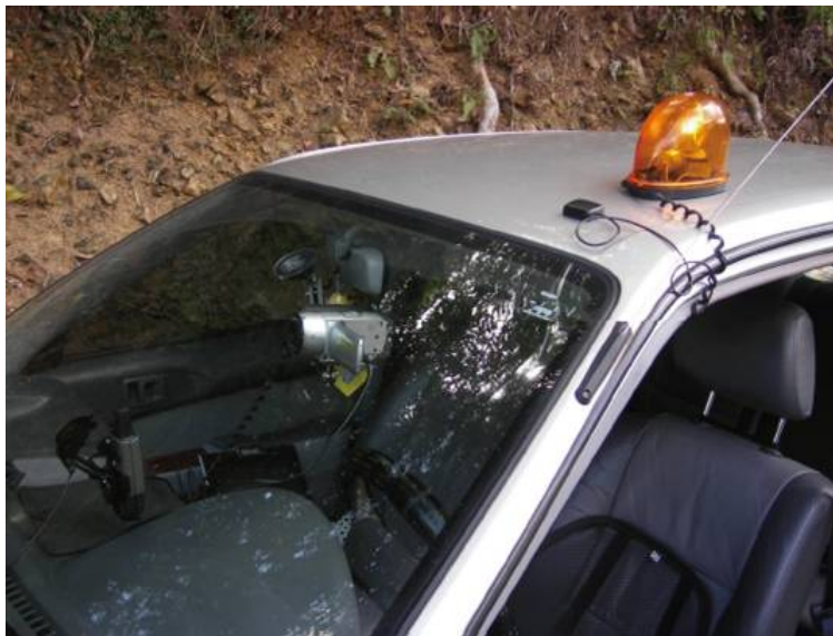
圖 2- 22 宜蘭縣鄉道影像拍攝設備架設圖二
