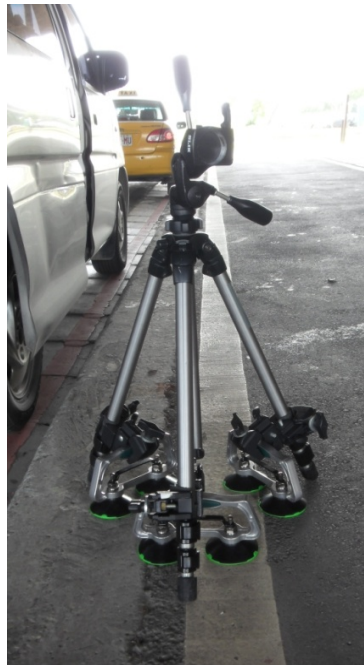
圖 4- 18 腳架利用吸盤固定
