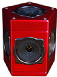
圖 4-5 全景球面視覺系統-瓢蟲 3 球面數位攝影機
