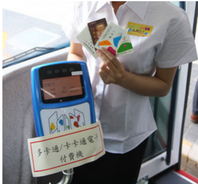
圖 3-11 智慧巴士一機多卡(悠遊卡、高捷卡、台灣通、e 通卡)驗票機
