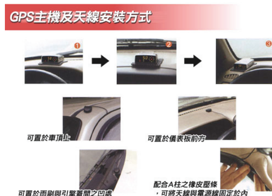
圖 3-6 GPS 主機及天線安裝方式
