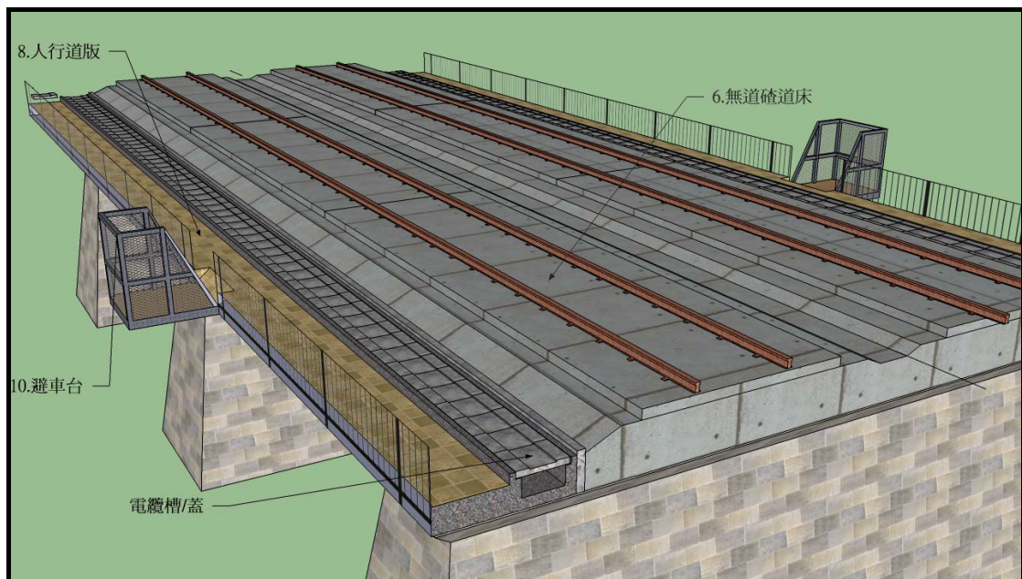
圖 2.3 無道碴道床鐵路橋構件所在位置示意圖
