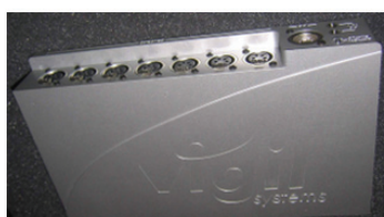
Hub：用來連接四臺攝影機+ 衛星定位器+慣性感應器
