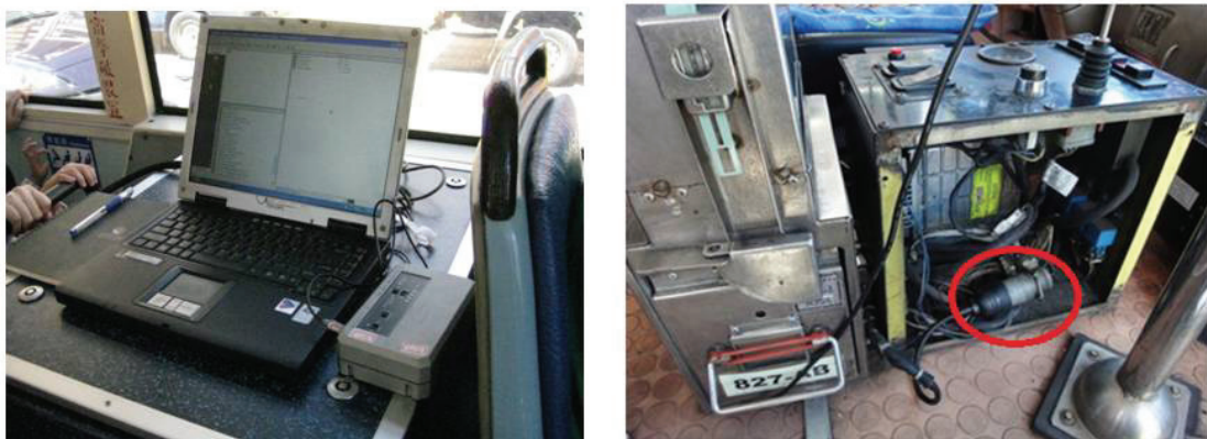
圖 8 大都會客運公司內部修車廠專用 OBDII 車輛診斷系統
