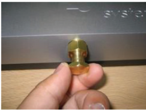
圖 81 Sensor Hub 上的六角螺栓
