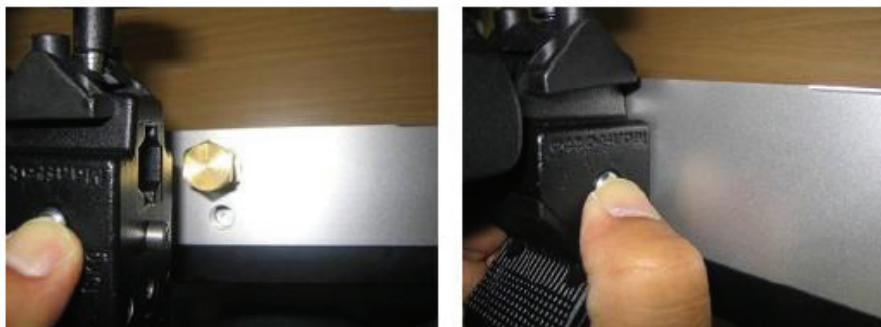
圖 83 萬用夾與 Sensor Hub 的安裝方法
